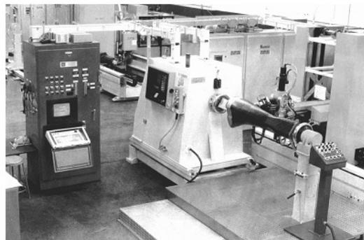
Figure 1-2 : à gauche, trajectoires de dépose sur le tube de queue de l'hélicoptère V-22 ; à droite, fabrication par placement de fibres [Pasanen05].
