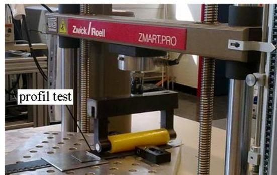
Figure 3-13 : essai de compression sur le profil test.
