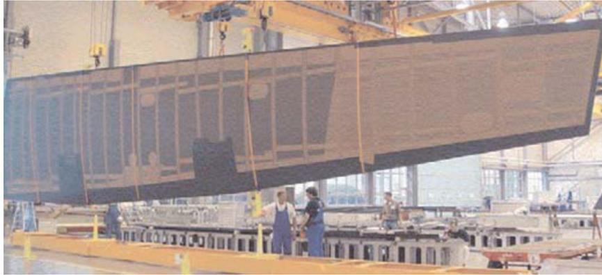
Figure 1-1 : aile de l'A400M. 23 mètres de long, 4 m de large au niveau de la jonction avec le fuselage, 3 tonnes environ [Uimm07].
