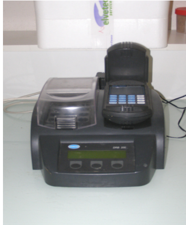
Figure II.2 : Colorimètre Hach pour le dosage de l'azote total.
