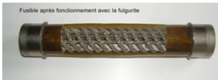
FIG. 1.7 – Fulgurite formée dans un fusible moyenne tension après fonctionnement [BUS 06].
