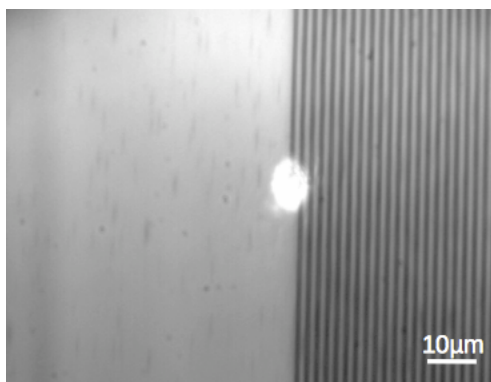
FIGURE 7.3: Composant plasmonique de période 2\ \mu\text{m} en cours de réalisation par usinage laser femtoseconde en configuration sub-micrométrique
