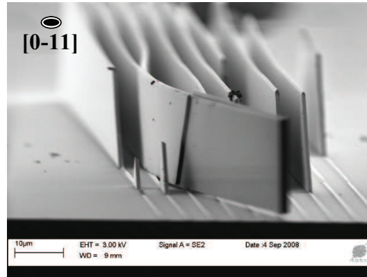
FIGURE 2.24 – Cliché MEB des mesas de la figure 2.23(a) après clivage.
