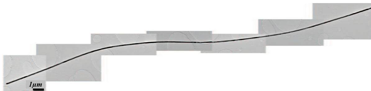
FIGURE 4.10 – Image MEB d'un NW de GaAs réalisé par VLS-HVPE. Longueur 50 \mu\text{m} et diamètre de 120 nm uniforme de la base au sommet.
