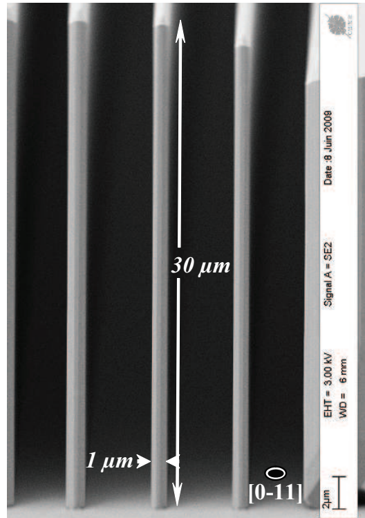
FIGURE 2.28 – Cliché MEB de bandes de la série D33 de 1\ \mu\text{m} de largeur et de 30\ \mu\text{m} de hauteur. Le rapport de forme est de 30. T=715\ ^\circ\text{C} , III/V=5 , \gamma = 6.22 et t=20\ \text{min} .
