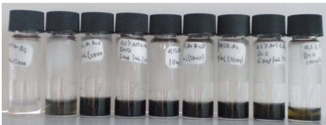
Figure 15 : Solutions de nanotubes de carbone (1mg/mL) dans du D2O avec du à différentes concentrations en « 5000-mono » (de 0.2 mg/mL à 100 mg/mL).
