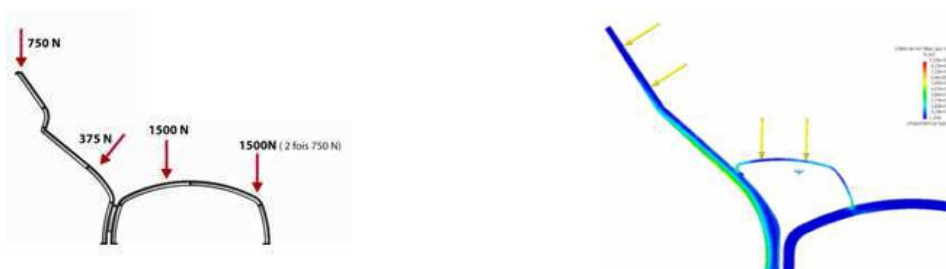
Figure 28 : Calcul de structure réalisé sous CATIA V5 pour la Chaise Longue Brevia
