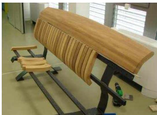
Figure 20 : Assemblage du prototype du Banc Sirocco
