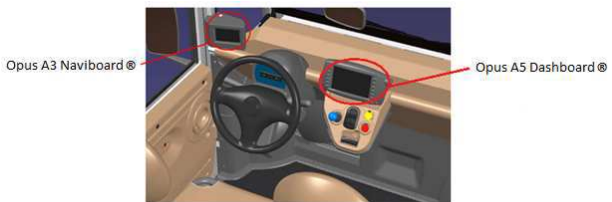
Figure 41 : Poste de conduite du Véhicule F-City équipé de l'Opus A3 Naviboard® et de l'Opus A5 Dashboard®
