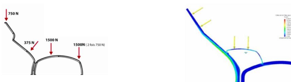
Figure 28 : Calcul de structure réalisé sous CATIA V5 pour la Chaise Longue Breva
