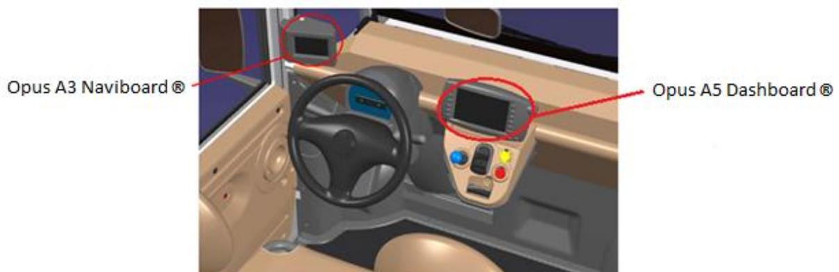
Figure 41 : Poste de conduite du Véhicule F-City équipé de l'Opus A3 Naviboard® et de l'Opus A5 Dashboard®
