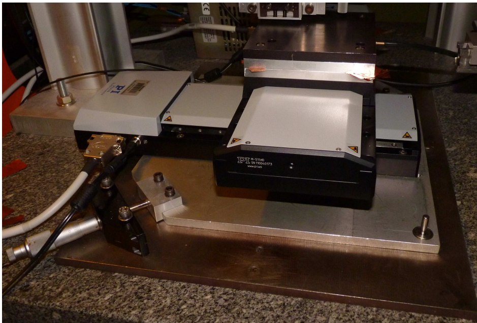
FIGURE 4.10 – La mise en place des platines de translation PI
