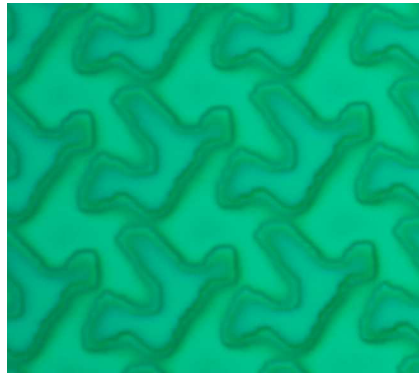
FIGURE 4.25 – Hologramme de 20 \times 20 pixels diffractant une matrice de 5 \times 5 points. Photo prise par un microscope optique de facteur grandissement \times 100 .
