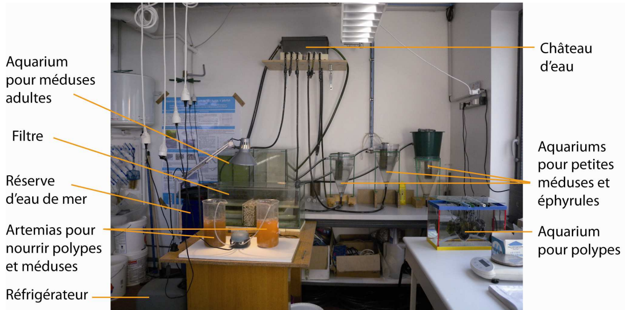
Figure 1.16 – Photo de l'installation permettant l'élevage des méduses au laboratoire.
