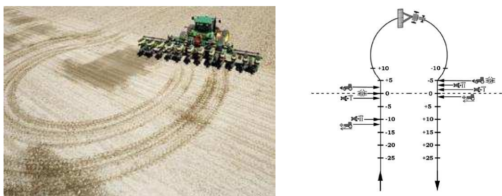
FIGURE 1.19 – Manœuvre de demi-tour en forme de boucle (src. John-Deere)
