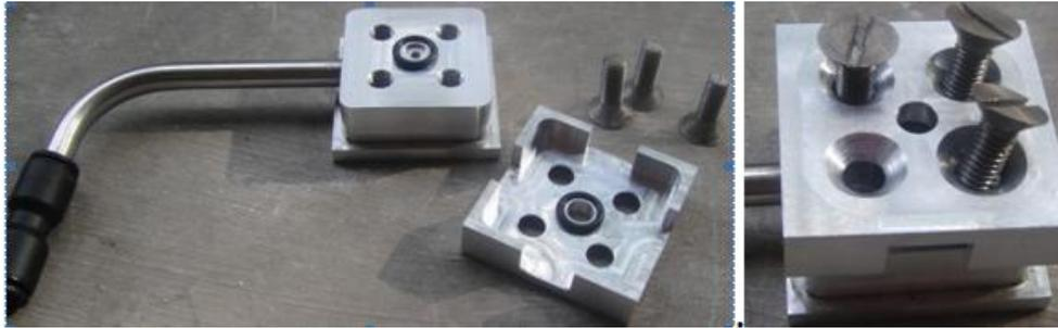
Figure 2.3-3. Porte échantillon à vis
