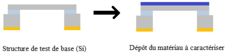
Figure 5.3-1. Structure de test bicouche
