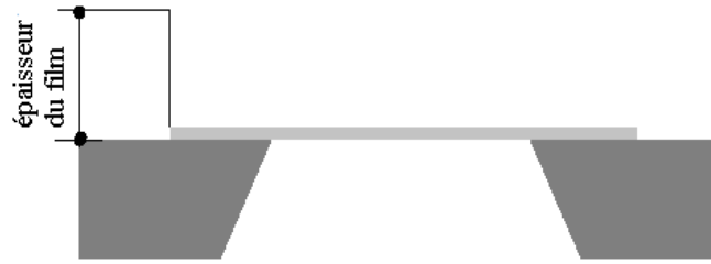
Figure 4.5-1. Gravure de marche autour de la membrane pour mesurer son épaisseur.
