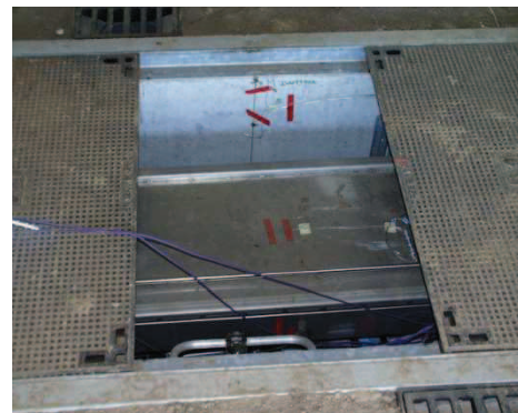
Figure II.10a. Salle d'essais CLIMA avec un emplacement d'étude d'armoire enterrée.
