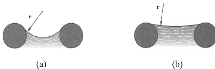
Figure I.9. Formes du ménisque : (a) évaporateur, (b) condenseur.
