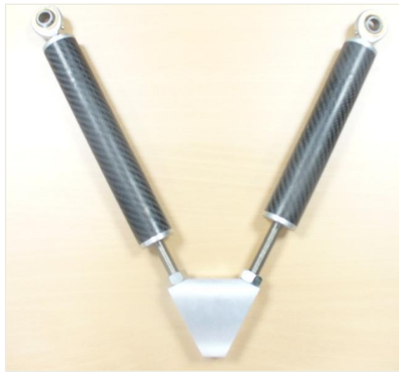
figure 22. – L'un des triangles supérieurs réalisé par les étudiants.
