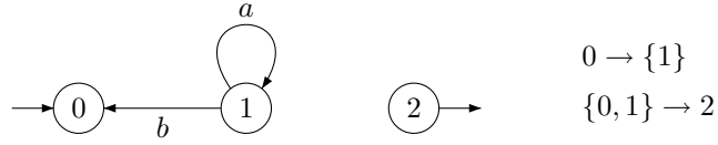
FIG. 2.13 – Automate acceptant le mot (a^{-\omega}b)^\omega .
