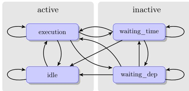
FIGURE 5.9 – Gestion du paramètre `task_state` par un ordonnanceur en-ligne
