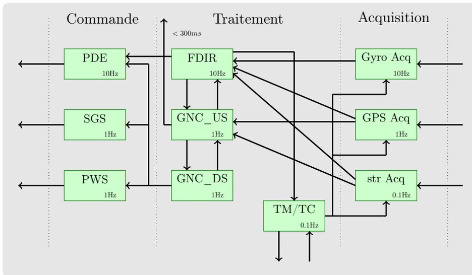
FIGURE 1 – Architecture logicielle simplifiée du FAS
