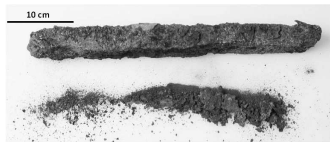
(b) Perte d'adhérence des produits de corrosion d'un lingot en fer forgé exposé durant deux ans à l'air
