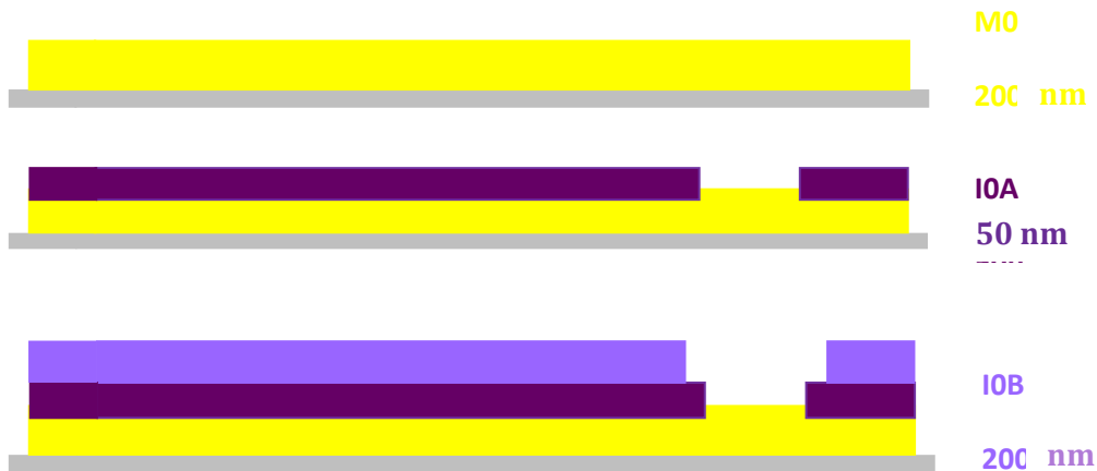
Figure I.20: Schéma d'une partie de circuit RSFQ faisant intervenir les différents éléments constitutifs (jonction Josephson shuntée, vias...).
