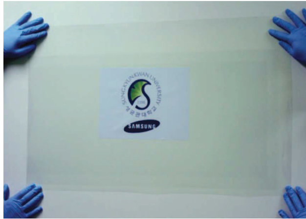
Figure I.17 : Panneau de graphène de 30 pouces. Photographie issue de [Bae10].
