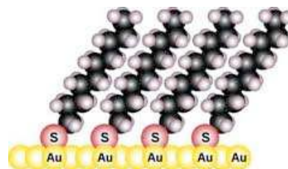
Figure 2.1 : Monocouche auto-assemblée de n -alcanethiols sur or. ( www.northwestern.edu )
