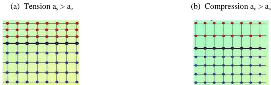
Figure I-18 : Représentation schématique de l'accommodation du paramètre de maille de la couche mince ( $a_c$ ) déposée sur un substrat ( $a_s$ ). Les contraintes au sein du film mince provoquent une déformation biaxiale en tension,  $a_s > a_c$  (a) ou en compression  $a_c > a_s$  (b).
