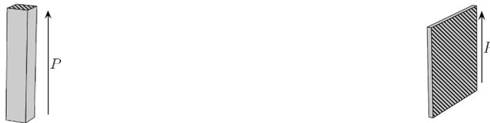
Figure I-7 : représentation de deux géométries possibles pour le calcul des coefficients piézoélectriques.
