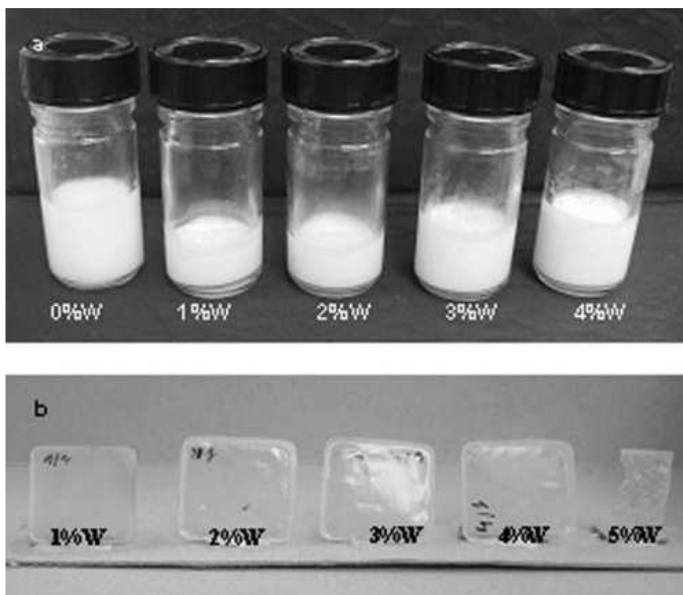
Figure III. 13: Images prises à l'aide d'un appareil photo numérique : (a) dispersions de nanocomposites contenant différents taux de whiskers, (b) films transparents obtenus après évaporations de l'eau
