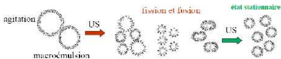
Figure III. 2: Représentation schématique du processus d'homogénéisation par ultrasons (US) [5]
