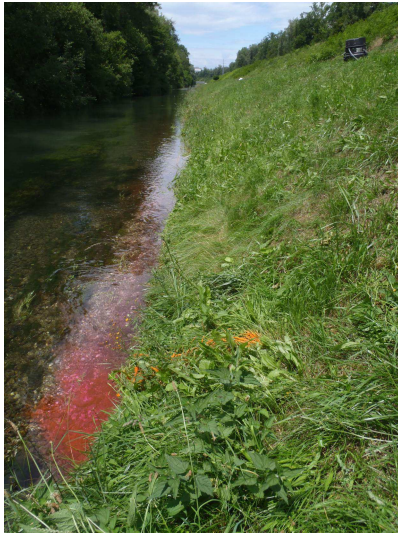
(a) Apparition dans le contre-canal du traceur injecté dans un piézomètre
