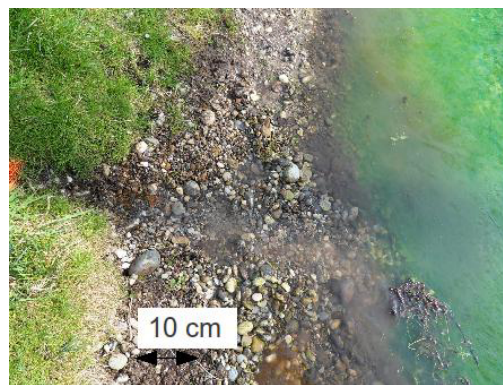
(b) Fuite localisée sur les cents premiers mètres amont du tronçon d'étude, présence majoritaire de matériaux grossiers.
