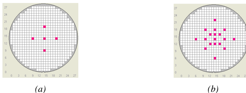
Figure 4.4 : schéma des puces mesurées au SEM pour la plaquette : exposée à condition nominale pleine plaquette (a) et exposée avec variation de dose et defocus (b)
