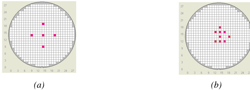
Figure 4.8 : schéma des puces mesurées à l'AFM sur la plaquette : exposée à condition nominale pleine plaquette (a) et exposée avec les variations de dose et defocus (b)
