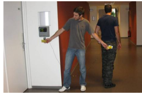
Figure II.26 – Utilisation d'un relais filaire
