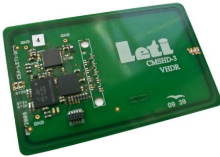
Figure III-58 – Carte sans contact d'expérimentation avec un front end F démodulant la phase
