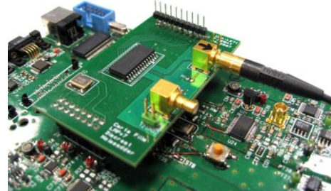
Figure V.15 – Le générateur de bruit
