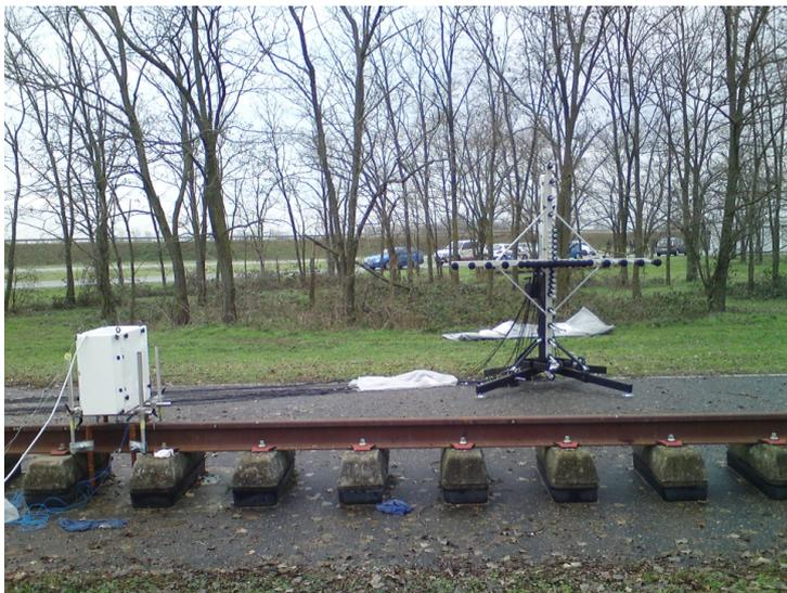
FIGURE 5.13: *Dispositif expérimental : pot vibrant et antenne microphonique.*
