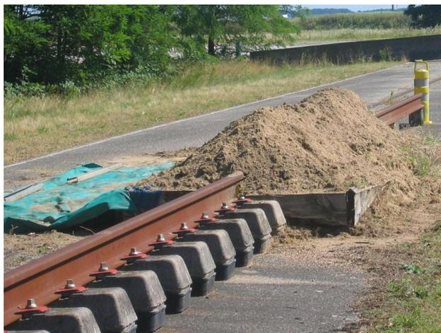
FIGURE 5.1: *Le rail expérimental du LIER. Extrémité ensablée pour éviter les réflexions en bout de rail.*
