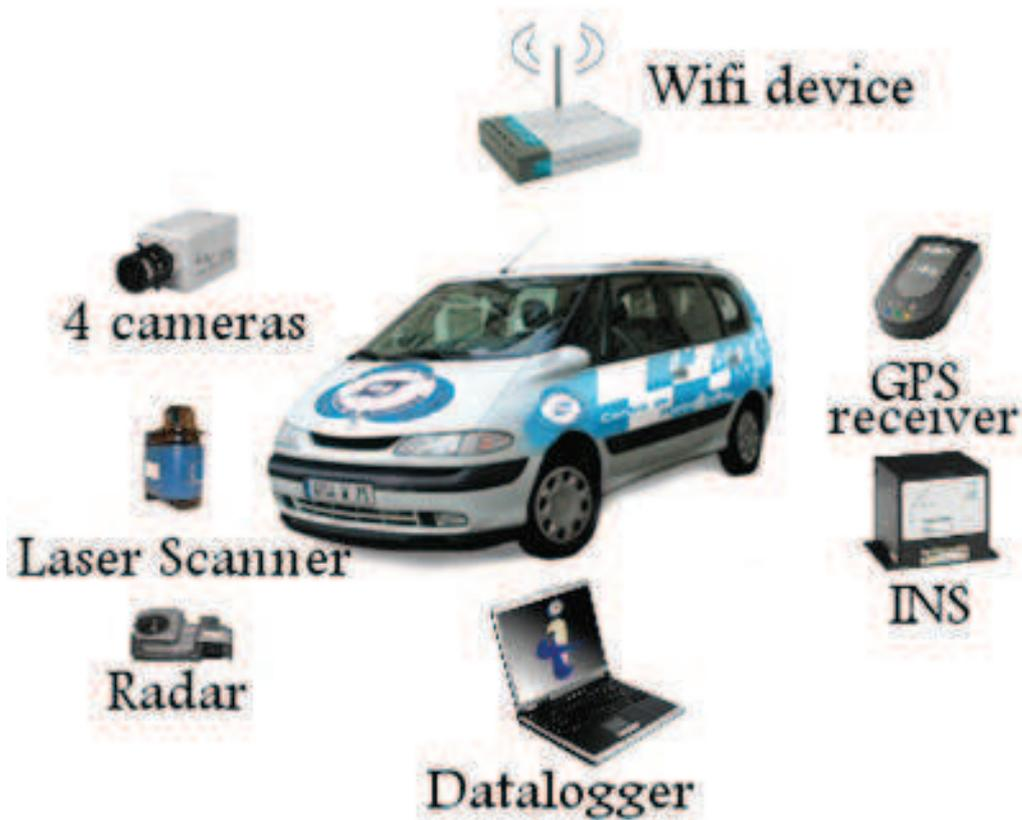
FIGURE 4.1 – Le prototype LaRA avec ses différents capteurs embarqués
