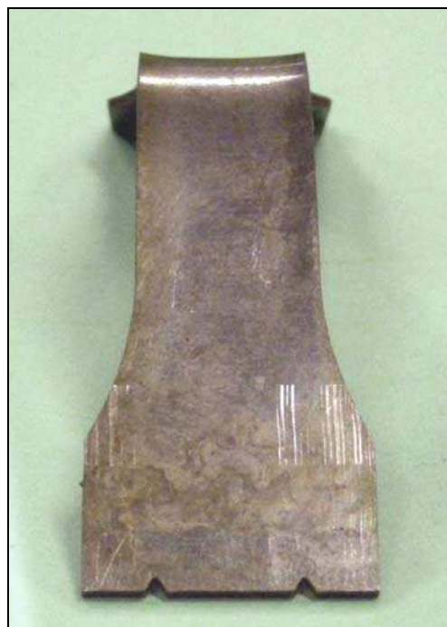
Figure 57. Epreuve pliée par flexion en l'air montrant une courbure anticlastique après son retour élastique.
