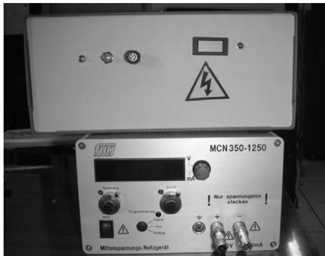
Figure 23: face avant de Gecopulse et de l'alimentation continue externe (Fug MCN 350-1250).
