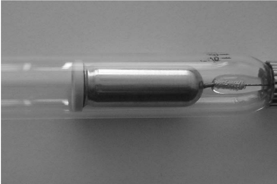
Figure 12: photographie d'une électrode creuse.
