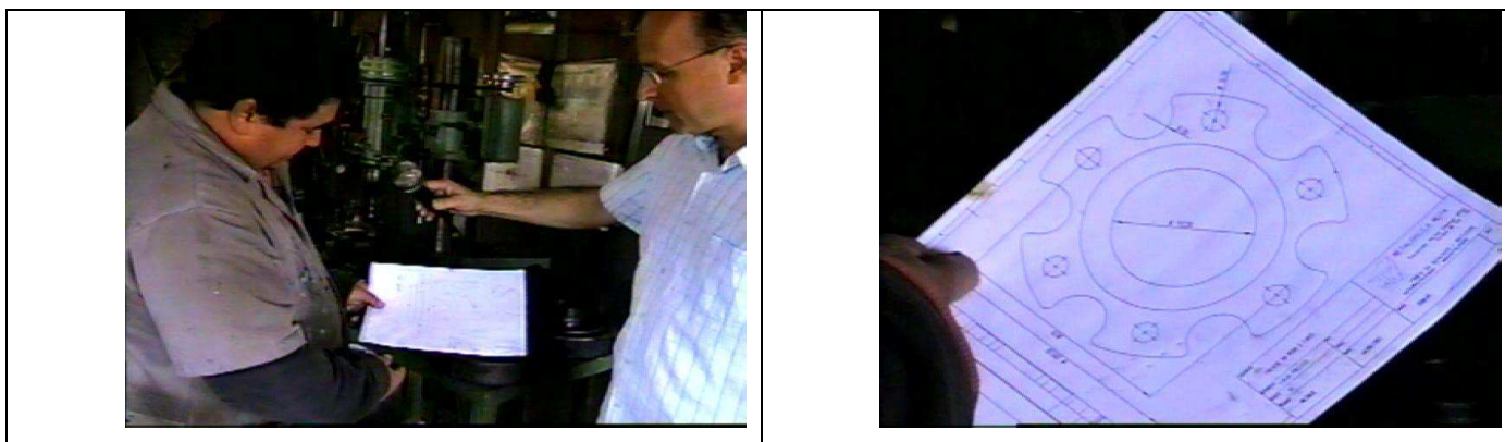
FIGURE 22 : LE DESSIN POUR LE PERÇAGE DU MOYEU DE ROUE
