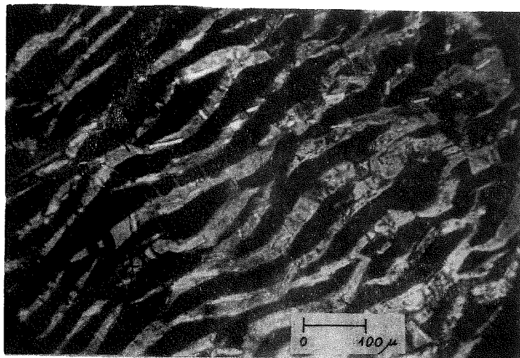
Fig. 24 - Structure micropertitique dans les migmatites hétérogènes de la Formation Jarasayatu. Les bandes noires sont d'orthose, les bandes claires sont d'albite An 5 - 8 (N+).
