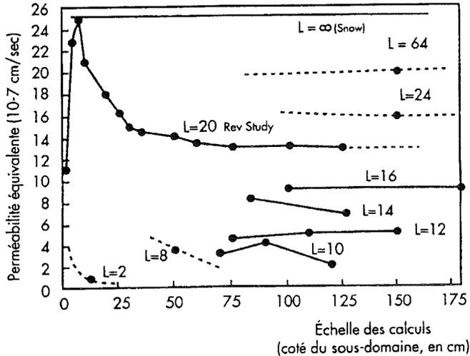
FIG. 4.- Perméabilité équivalente en fonction de la dimension (côté) du domaine étudié, en cm, et de la dimension des fractures. D'après Long et Witherspoon [1985] et Massonnat [1994].
