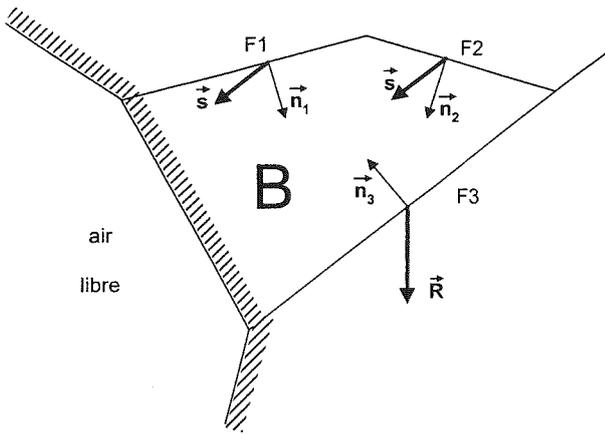
FIG. 178.- Illustration en 2D de la condition de glissement du bloc B sur une seule de ses faces. Pour les faces F1 et F2, on a  $\vec{s} \cdot \vec{n}_i > 0$ . Pour la face F3,  $\vec{R} \cdot \vec{n}_3 < 0$ , ce qui indique un déplacement possible selon le vecteur  $\vec{s}$ , dans le plan de la face F3.
