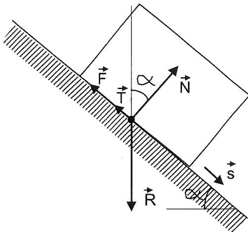
FIG. 173.- Les forces agissant sur un bloc à l'équilibre.  $\vec{N}$  est la réaction du support,  $\vec{T}$  la force de frottement,  $\vec{R}$  la résultante de toutes les autres forces actives, dont le poids, et  $\vec{F}$  est la force fictive assurant le maintien de l'équilibre.
