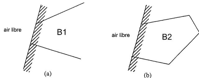
FIG. 165.- Deux exemples de blocs « infini » (B1) et fini (B2). La zone hachurée représente la paroi de l'escarpement rocheux.
