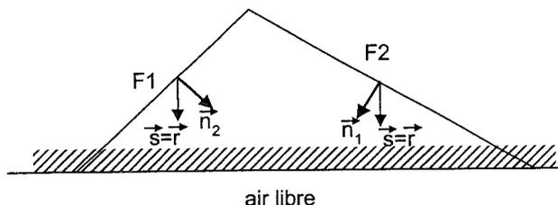
FIG. 176.- Dégagement d'un bloc libre par décollement. La pyramide des joints est constituée à partir des 2 faces F1 et F2. Le déplacement se fera selon le vecteur  $\vec{s}$  tel que  $\vec{s} \cdot \vec{n}_1 > 0$  et  $\vec{s} \cdot \vec{n}_2 > 0$ .
