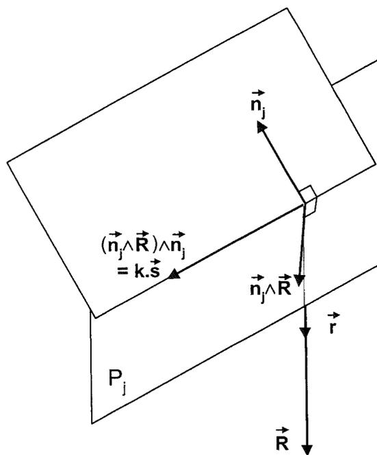
FIG. 177.- Glissement d'un bloc sur une de ses faces (dans le plan  $P_j$ ).  $\vec{R}$  est la résultante des forces extérieures, dont le poids du bloc.  $\vec{n}_j$  est le vecteur normal à  $P_j$ , unitaire et vers l'intérieur du bloc. Le déplacement  $\vec{s}$  se fait selon la ligne de plus grande pente, et dans le sens donné par le vecteur  $(\vec{n}_j \wedge \vec{R}) \wedge \vec{n}_j$ .
