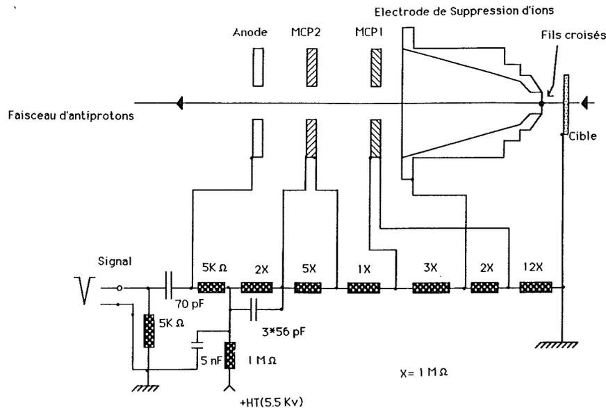
Figure 2.14: Schéma synoptique du détecteur d'électrons [15]
