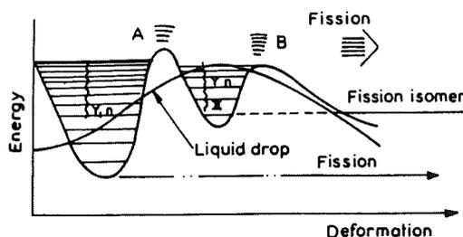
Figure 1.10: Diagramme schématisique de la double barrière de fission, [41]
