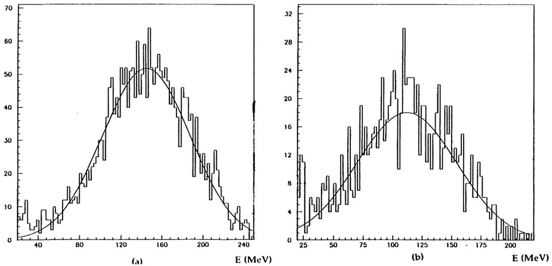
Figure 2.28: Distribution en énergie cinétique totale des fragments de fission pour une cible (a) d'uranium (b) de bismuth.
