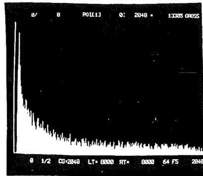
Figure 2.18: Spectre d'électrons en coïncidence avec les  $\alpha$ , [15]
