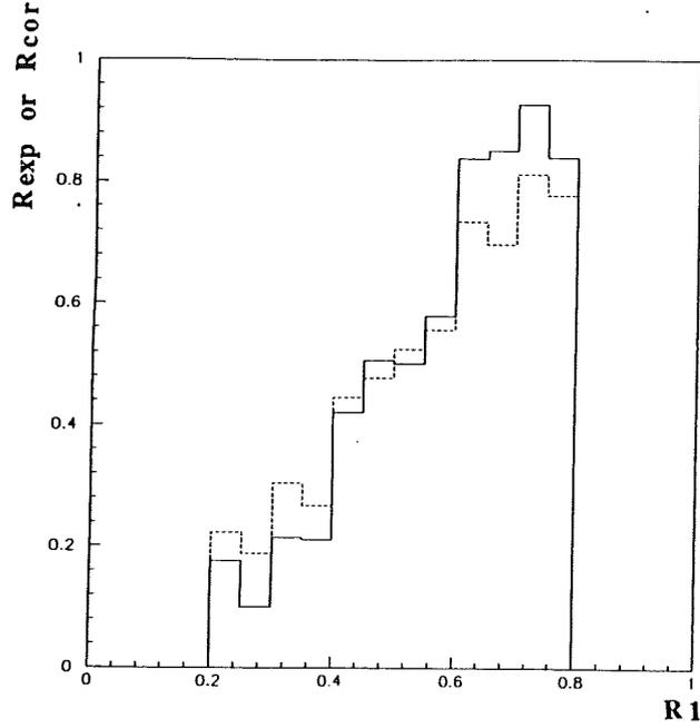
Figure 4.3: L'attachement de la particule  $\Lambda$  en fonction de la masse du fragment de fission. La courbe en trait plein est purement expérimentale, celle en pointillés est corrigée par les effets d'efficacité.
