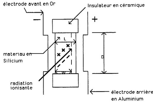
Figure 2.21: détecteur à barrière de surface, [57]
