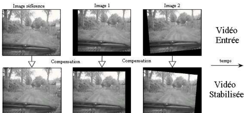
FIGURE 5.5 – Séquence d'images synthétiques instable (en haut) et séquence après stabilisation (en bas).
