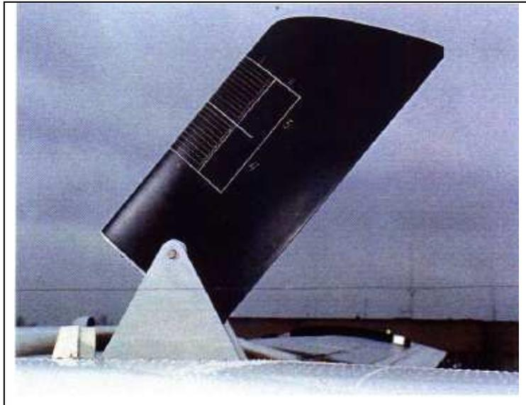
*Figure A.I-9. Photographie d'un profil d'aile NACA 0012 à l'échelle réduit utilisé pour les tests en soufflerie et en condition naturelle de givrage*
