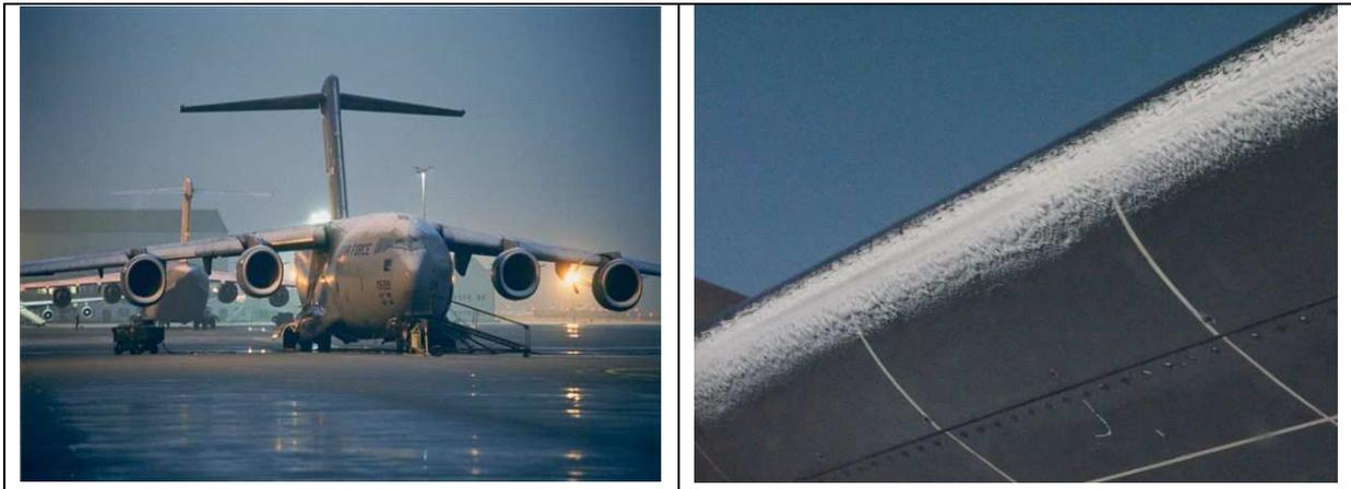
**Figure A.I-5. Exemple de givrage sur avion : image Boeing C-17 Globemaster 3. Givrage aile**
