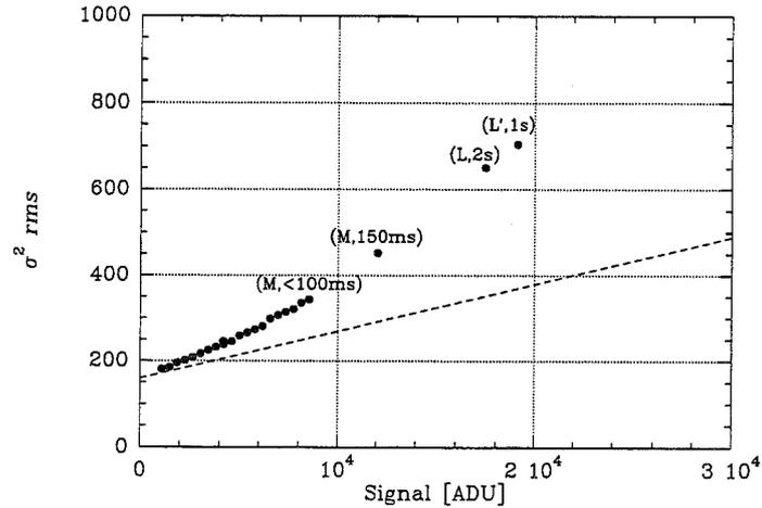
**Figure III.8** – Courbe  $\sigma_{rms,tot}^2$  exprimé en ADU en fonction du signal  $\langle S_{ADU,tot} \rangle$  (voir texte). La courbe en pointillés représente la limite  $\langle S_{ADU,tot} \rangle / G + RON_{ADU}^2$ . Les barres d'erreur sont de l'ordre de la taille des symboles.
