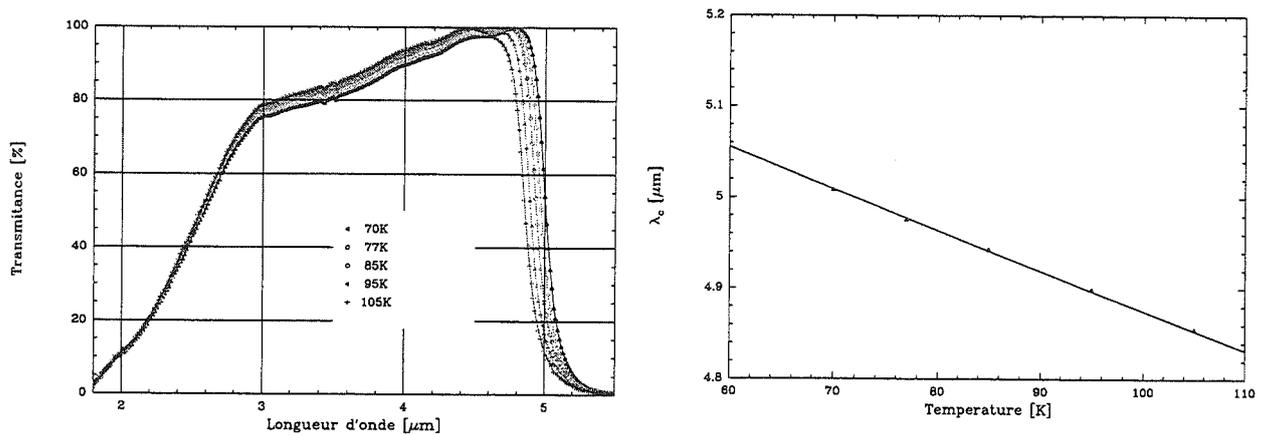
**Figure II.13** – a- Dépendance en température de la réponse spectrale d'une diode photo-voltaïque. b- Variation de la longueur d'onde de coupure en fonction de la température des diodes (triangles). La relation de Hansen (traits pleins) est bien vérifiée.
