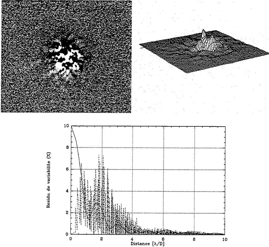
**Figure V.20** – Résidus de variabilité de la FEP dans la bande K. Le cercle représenté sur l'image délimite l'extension du halo sur les FEP avant soustraction. Pour comparaison est tracé le profil radial de la FEP théorique.
