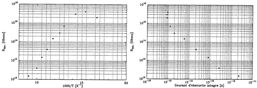
Figure II.50 – Caractéristiques  $R_{mes}(T)$  à l'obscurité, et  $R_{mes}(I_{ds,obs})$
