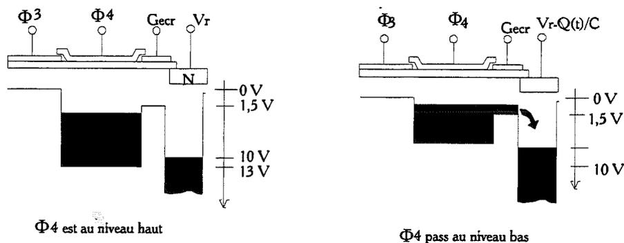
Figure II.32 – Principe de fonctionnement de l'étage de sortie
