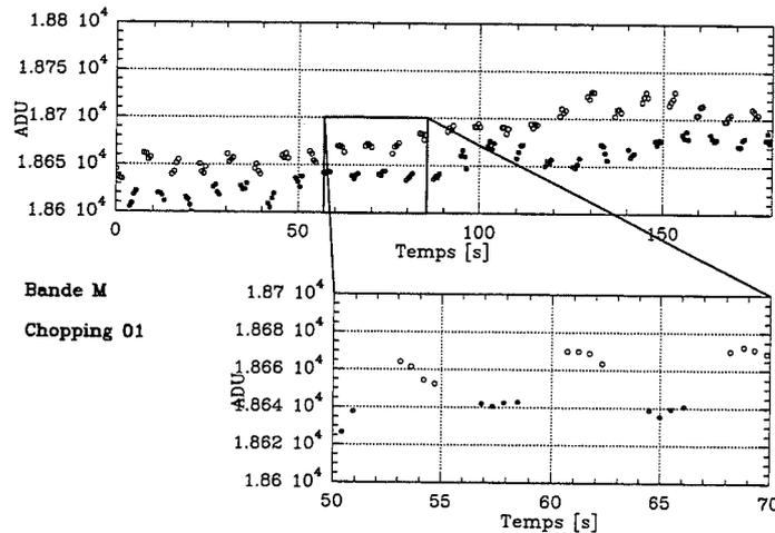
**Figure IV.1** – Variation du fond émissif, instrumental et fond de ciel, sur une séquence d'acquisition en bande M. Aspect temporel. Ronds pleins: position "on". Ronds creux: position "off". L'humidité extrérior est de l'ordre de 10-20%.
