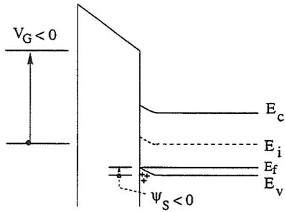
Cas  $V_G < 0$ : régime d'accumulation. Les bandes à la surface du semiconducteur sont courbées vers le haut et le potentiel de surface  $\psi_s$  est négatif. Le niveau de Fermi se rapproche de la bande de conduction. La concentration en trous s'en trouve augmentée ce qui donne lieu à une fine couche chargée positivement, de charge  $Q_{sc}$ . Elle est équilibrée par une charge négative  $Q_M$  à l'interface métal-oxyde,  $Q_M = -Q_{sc}$ . On est en régime d'accumulation.
