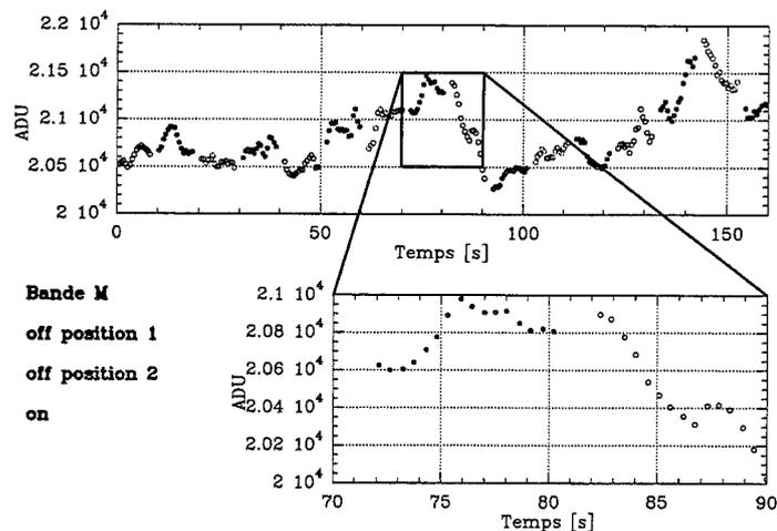
Figure IV.4 – Un autre exemple de variation du fond émissif, instrumental et fond de ciel, sur une séquence d'acquisition en bande M. Aspect temporel. Ronds pleins: position "on". Ronds creux: position "off1" et "off2". Les conditions d'humidité sont ici peu favorables, cf IV.1 (humidité supérieure à 50%).
