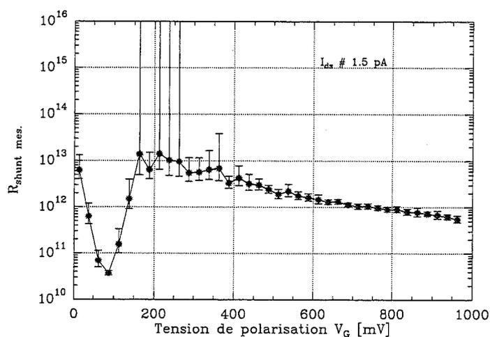
Figure II.39 - Caractéristique  $R_{mes}(V_G)$
