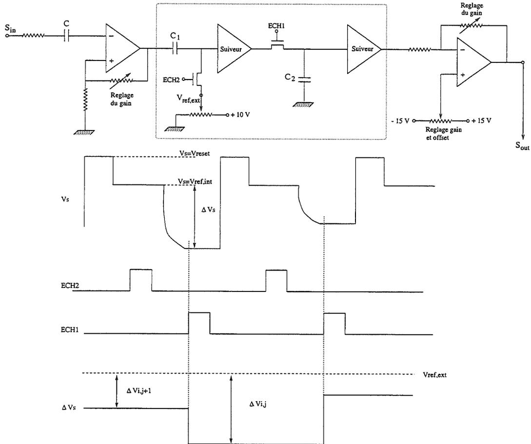
Figure II.24 – Schéma de principe du double échantillonneur corrélé. a- Montage électronique. b- Chronogramme de fonctionnement.
