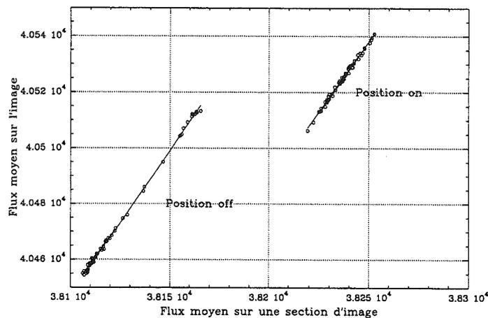
Figure IV.12 – Variation spatiale du fond émissif, instrumental et fond de ciel (bande M) avec optique adaptative inactive
