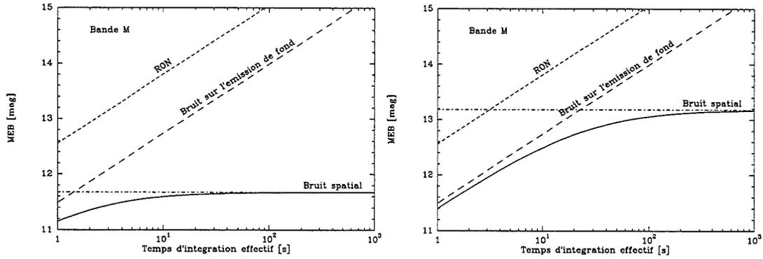
Figure VI.3 – Magnitude équivalente au bruit en bande M. A gauche, optique adaptative inactive sur le ciel. A droite, optique active.
