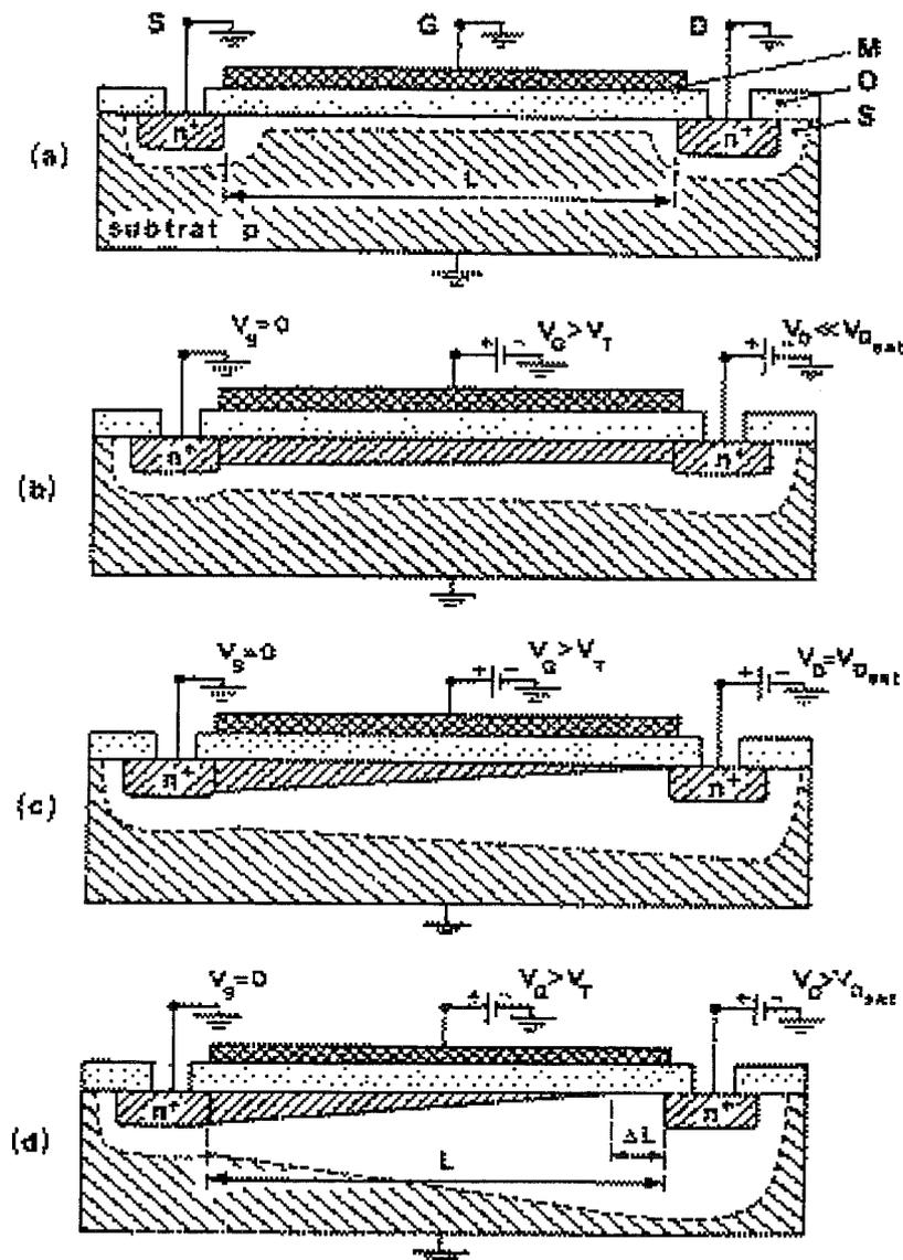
Figure II.10 - Etat du canal en fonction de  $V_{ds}$
