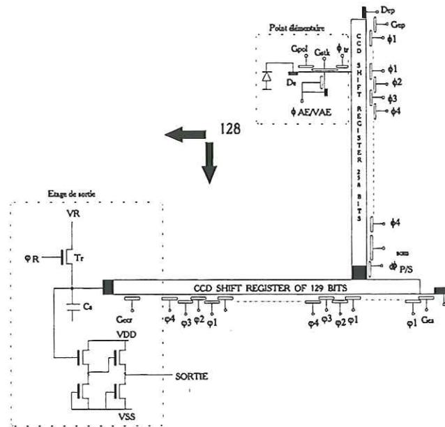
Figure II.33 - Schéma de principe du dispositif IRCCD 128X128
