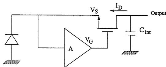
Figure VI.4 – Etage d'entrée à injection directe contre-réactionnée.
