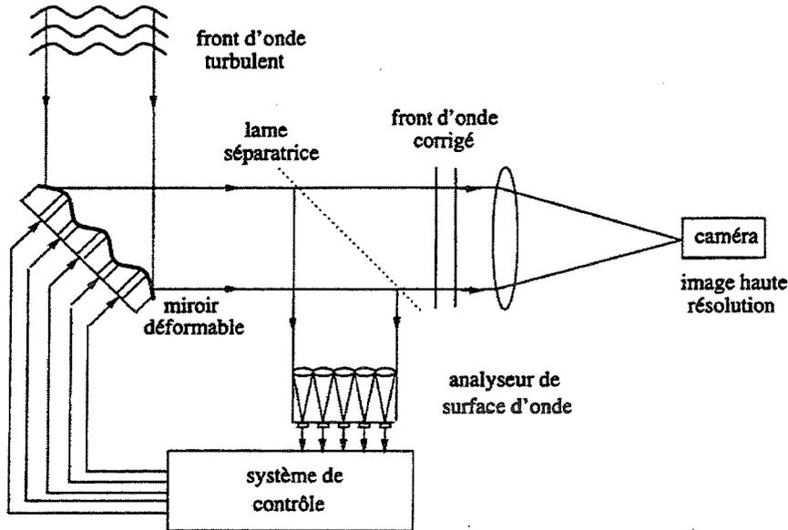
Figure I.4 – Principe de fonctionnement d'un système d'Optique Adaptative.
