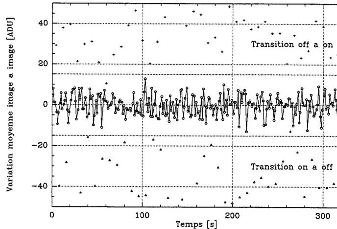
**Figure IV.2** – Variation pose à pose du fond émissif, instrumental et fond de ciel, sur une séquence d’acquisition. Aspect temporel. Ronds: variation en position “on” ou “off” dues aux variations de fond de ciel, triangles: variation “on” à “off”, croix: variation “off” à “on”
