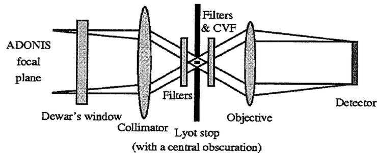
Figure II.55 – Schéma d'ensemble de l'optique de la caméra
