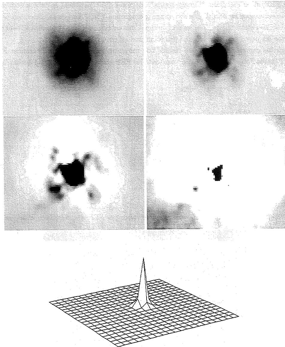
Figure V.21 - Image déconvoluée après 250, 500, 750, 1000 et 5000 itérations (image et vue en surface).
