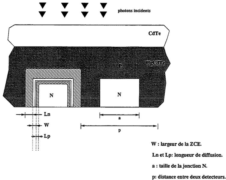
Figure II.19 – Schéma du volume sensible du détecteur
