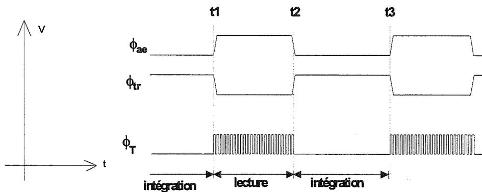
Figure II.30 – Chronogramme de lecture.  $\phi_{ae}$  est la phase d'anti-éblouissement-poubelle,  $\phi_{tr}$  est la phase trape et  $\phi_T$  schématise les phases qui commandent le dispositif à transfert de charges.
