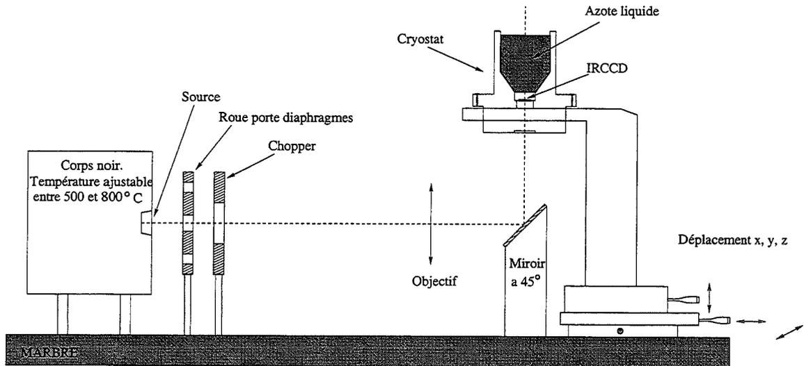
Figure II.23 – Schéma du banc d'optique
