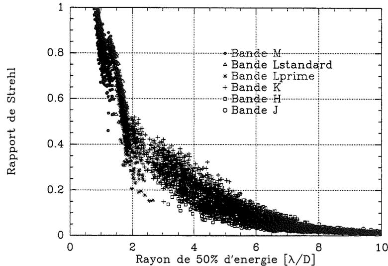
**Figure V.10** – Rapport de Strehl en fonction du rayon encerclant 50 % de l'énergie pour la totalité des images prises pendant les quatre nuits d'observation en J, H, K, L, L' et M.
