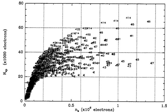
Figure II.53 – Registres séries: perte en charge en fonction de la charge transportée. Statistique sur toute la matrice
