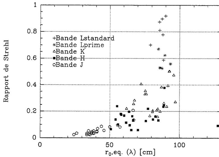
Figure V.26 - Rapport de Strehl en fonction de  $r_{0,eq}$
