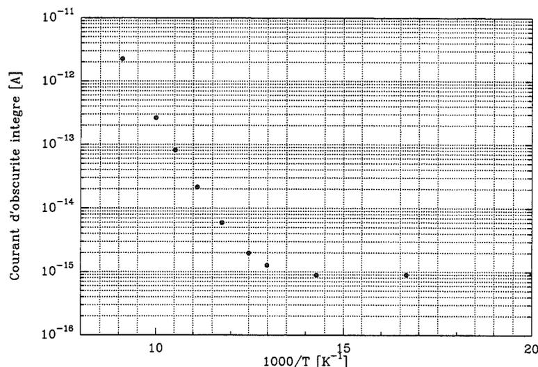
Figure II.48 – Courant d'obscurité en fonction de la température.
