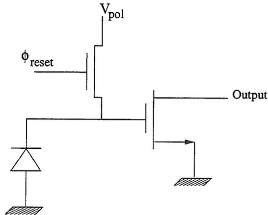
Figure VI.5 – Etage d'entrée à lecture directe en tension.
