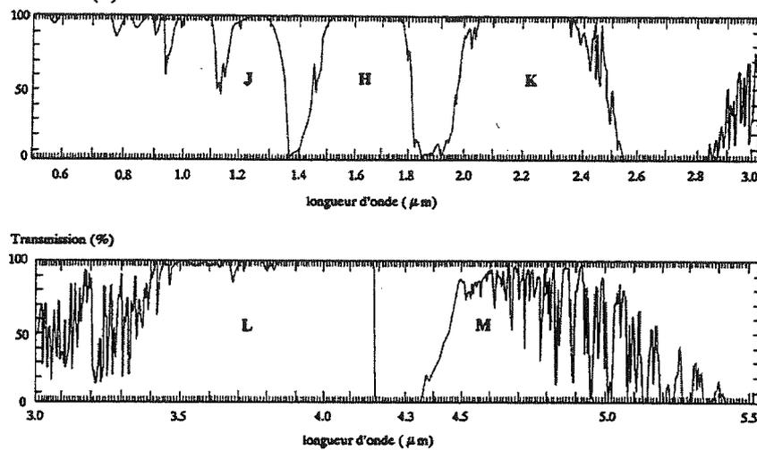
Figure I.2 – Fenêtres atmosphériques entre 1 et 5  $\mu\text{m}$ .
