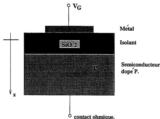
Figure II.2 – Schéma de principe d'une structure MOS
