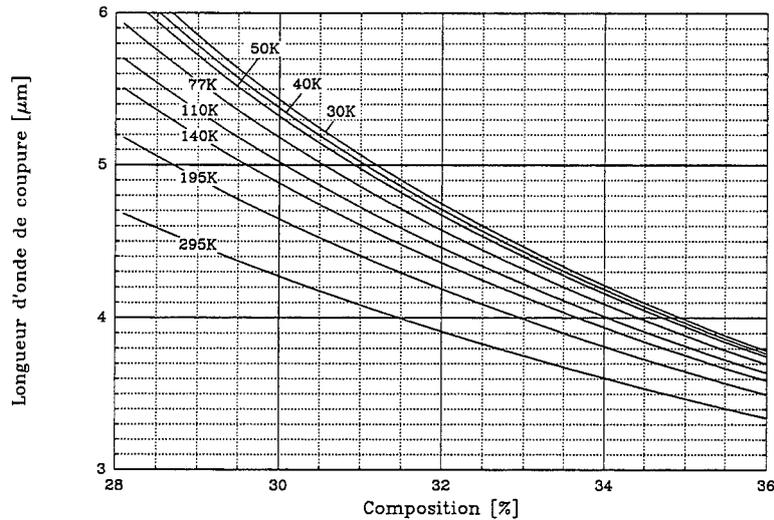
Figure II.12 – Simulation de la variation de la longueur d'onde de coupure du matériau  $Hg_{1-x}Cd_xTe$  en fonction de la température  $T$  de la diode et de la composition métallurgique  $x$ , d'après la relation de Hansen.
