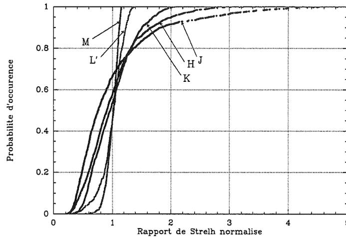
**Figure V.8** – Fonction de répartition du rapport de Strehl sur les poses individuelles (normalisée au rapport de Strehl moyen), dans les bandes J, H, K, L' et M.
