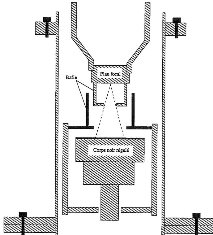
Figure II.26 – Schéma du cryostat faible flux de fond
