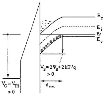
Cas  $V_G > V_{th}$ : Forte inversion. Le potentiel de surface est supérieur à  $2\psi_b + \frac{2kT}{q}$ . A la surface semiconducteur-oxyde,  $n \gg N_A$ . La couche d'inversion est établie; c'est elle qui encaisse toute variation de charge. La largeur de la zone désertée reste de l'ordre de  $x_{dmax}$ . La charge positive côté métal a pour valeur:  $Q_M = -Q_n + qN_A x_{dmax}$ .
