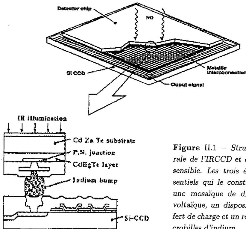
Figure II.1 - Structure générale de l'IRCCD et de l'élément sensible. Les trois éléments essentiels qui le constituent sont: une mosaïque de diode photo-voltaïque, un dispositif à transfert de charge et un réseau de micro-billes d'indium.
