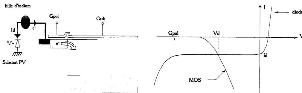
Figure II.27 – Point de fonctionnement de l'étage d'entrée
