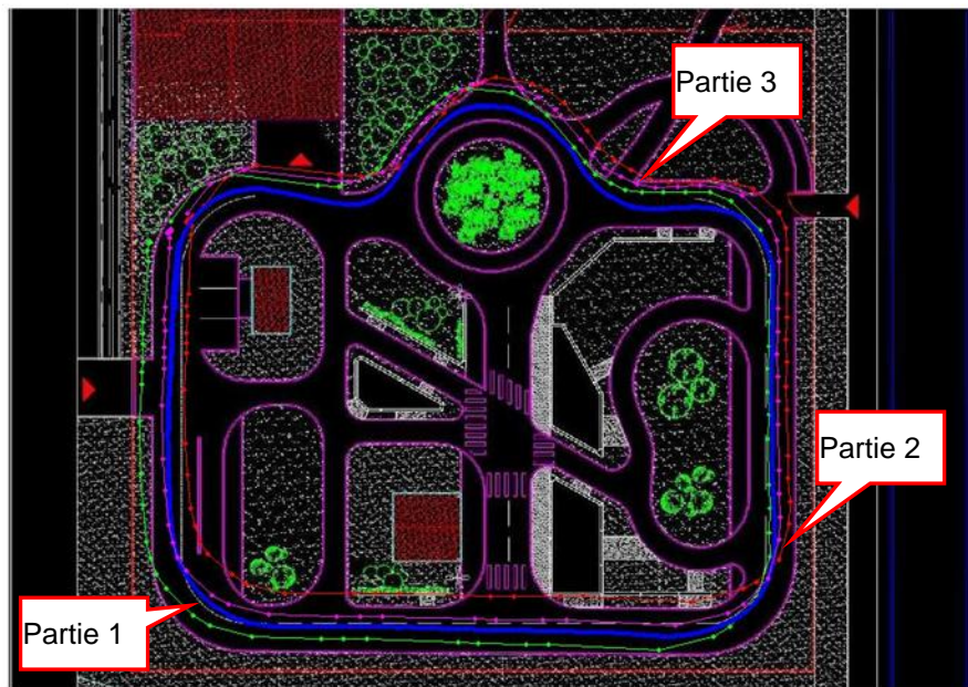
Figure III- 43 PAVIN- trace d'un mobile avec 3 récepteur GPS
