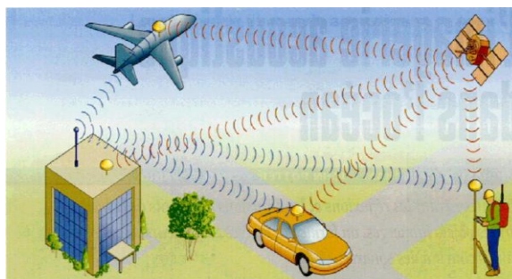
Figure II- 16 Architecture d'un système GPS différentiel
