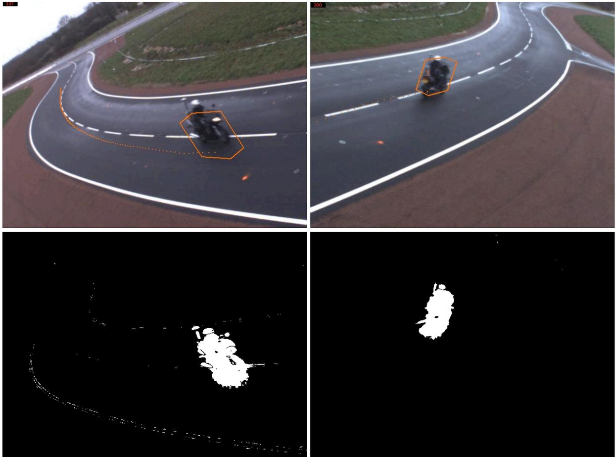
FIGURE 5.9 – Gauche : entrée de courbe. Droite : sortie de courbe. Enveloppe estimée et trajectoire de la moto. Haut : images couleur. Bas : images binaires d'avant-plan.
