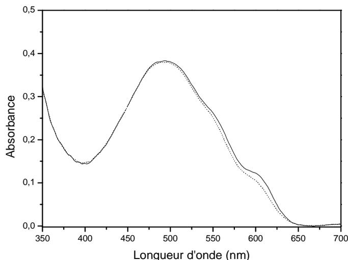
**Figure 112. Evolution du spectre d'absorption UV-visible du mélange P3HT / PC<sub>60</sub>BM sur Verre / ITO / PEDOT:PSS au cours du vieillissement naturel en absence d'oxygène**
