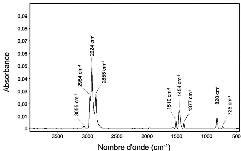
Figure 32. Spectre IR du P3HT avant vieillissement
