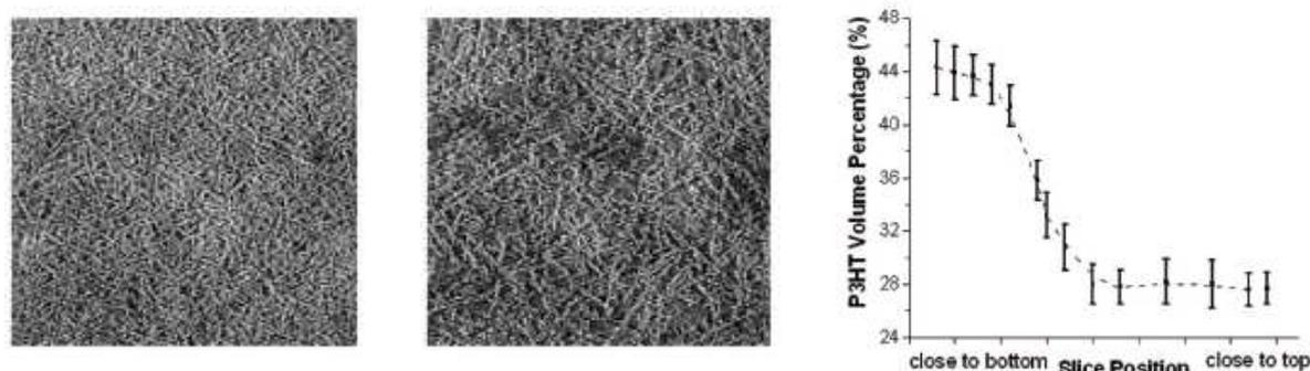
**Figure 8. Mise en évidence par tomographie électronique du gradient de composition vertical de la couche active P3HT / PC<sub>60</sub>BM d'une cellule après recuit thermique. Clichés MET (1,7 µm x 1,7 µm) d'une tranche située respectivement à proximité de l'anode (Gauche) ; à proximité de la cathode (Centre) ; évolution de la fraction volumique de P3HT en fonction de l'épaisseur (Droite)** <sup>[73]</sup>
