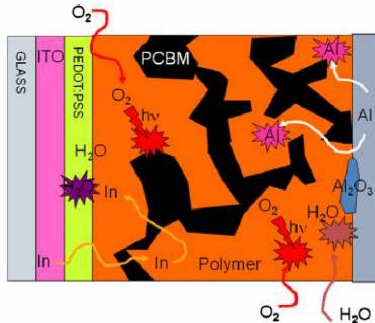
Figure 12. Vue en coupe d'une cellule et des différents processus intervenant lors de la dégradation du dispositif <sup>[11]</sup>
