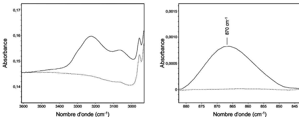
**Figure 55. Thermolyse d'un échantillon de P3HT photo-oxydé 150 h**
