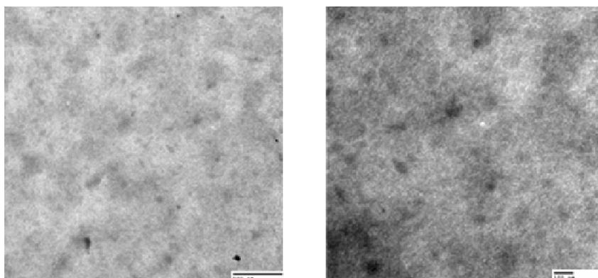
**Figure 105. Clichés MET de la couche active d'un échantillon de la série P180 après 3000 h de photolyse
