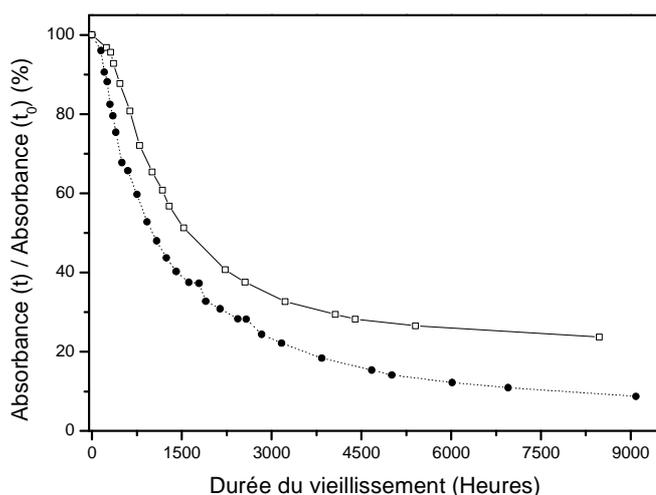
**Figure 82.** Influence du PC<sub>60</sub>BM sur la vitesse de dégradation du P3HT au cours de la thermo-oxydation à 100°C. Evolutions normalisées de l'absorbance à 520 nm
