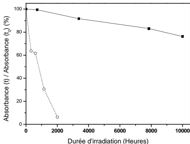
**Figure 69. Evolution de l'absorbance du P3HT et du MDMO-PPV au cours de la photolyse**
