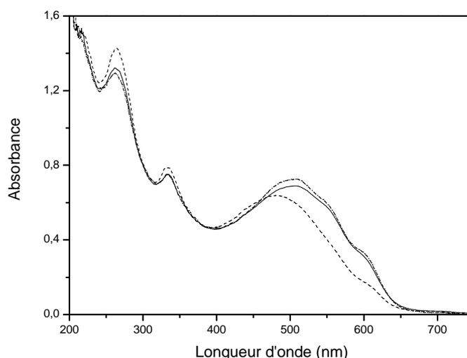
**Figure 111. Evolution du spectre d'absorbance UV-visible du mélange P3HT / PC<sub>60</sub>BM sur substrat inerte au cours du vieillissement naturel en absence d'oxygène (- - -)  $t_0$  ; (—) 1 an ; (- • -) 2 ans**
