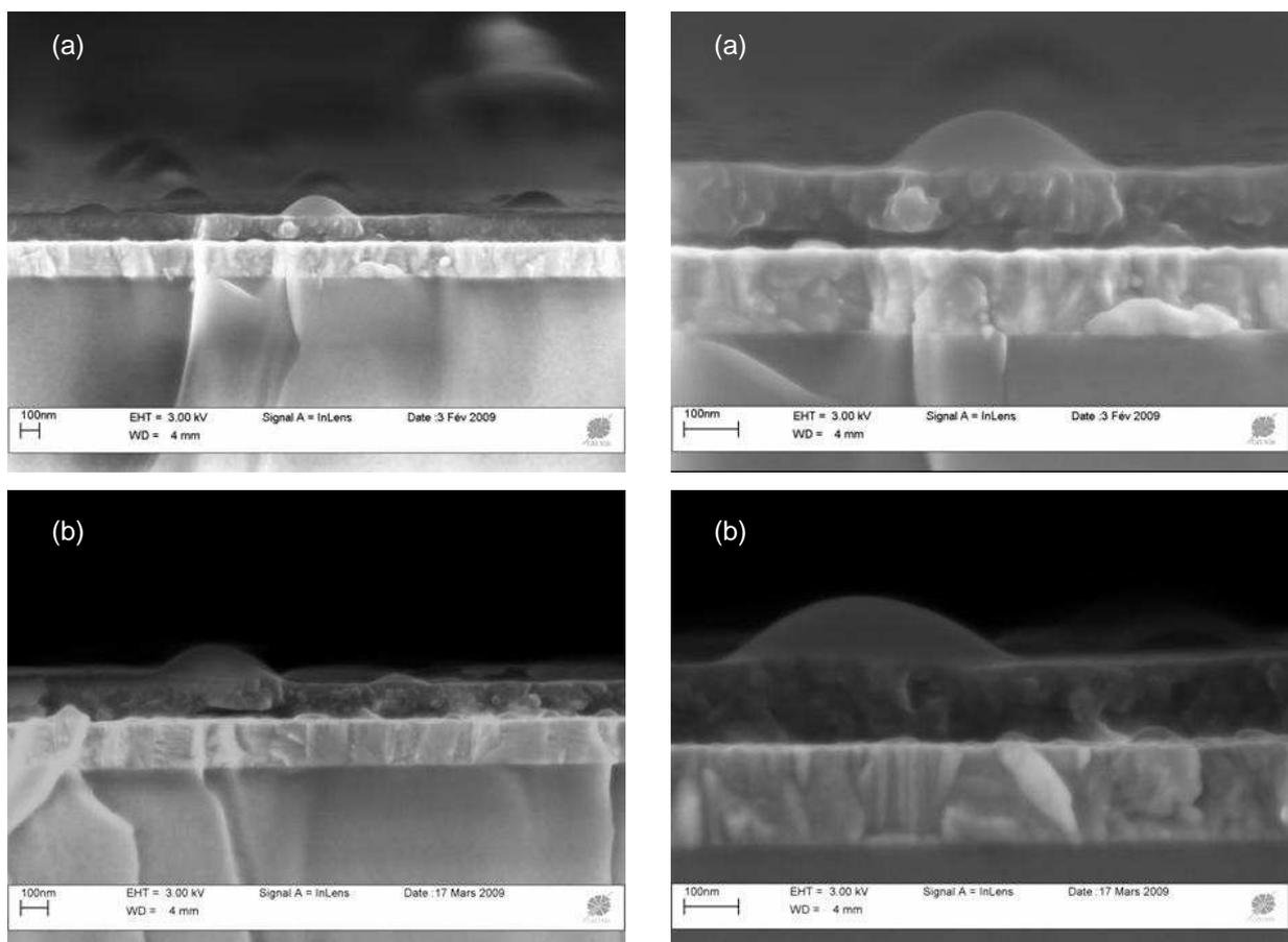
**Figure 92. Clichés MEB de la tranche d'un échantillon après (a) 4500 h et (b) 6000 h de photolyse
