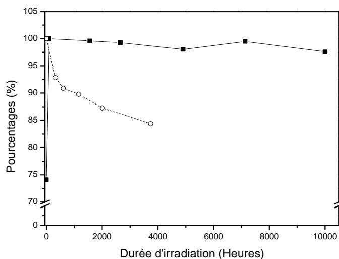
**Figure 83. Evolutions normalisées de l'absorbance des mélanges X / PC<sub>60</sub>BM au cours de la photolyse à  $\lambda > 295$  nm et T = 60°C**
