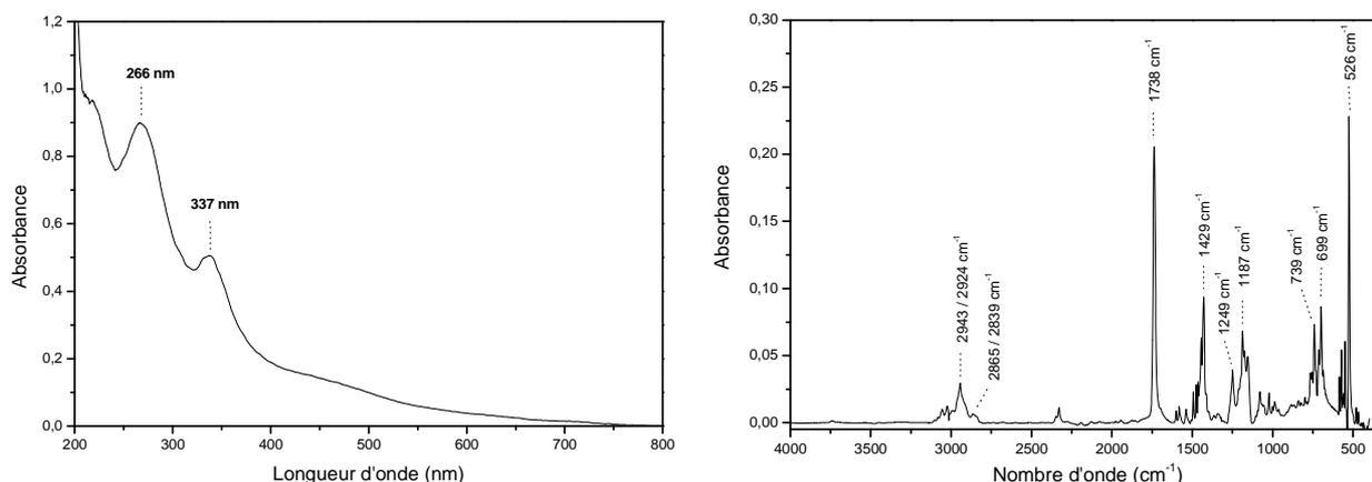
Figure 74. Spectres UV-visible (Gauche) et IR (Droite) du PC<sub>60</sub>BM
