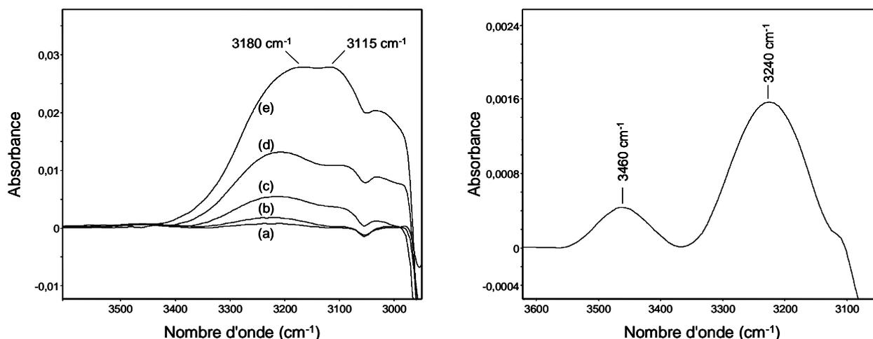
**Figure 35. Evolution du spectre IR du P3HT au cours de la photo-oxydation dans la zone  $3600 - 3000\text{ cm}^{-1}$ . Soustraction entre le spectre de l'échantillon irradié et le spectre initial**
