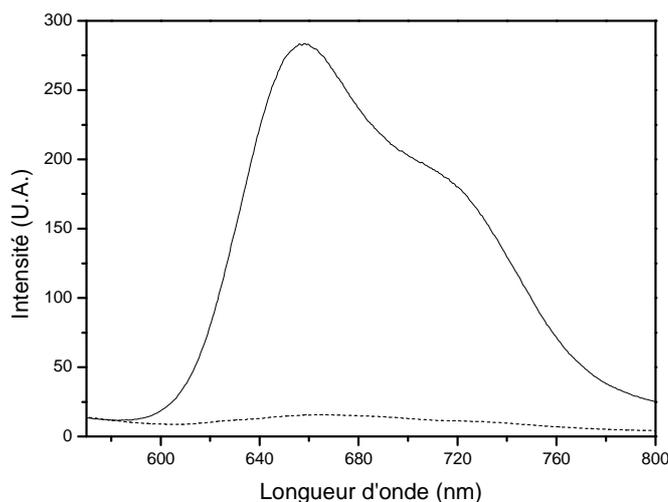
**Figure 81.** Mise en évidence de la désactivation de l'état singlet du P3HT par le PC<sub>60</sub>BM
