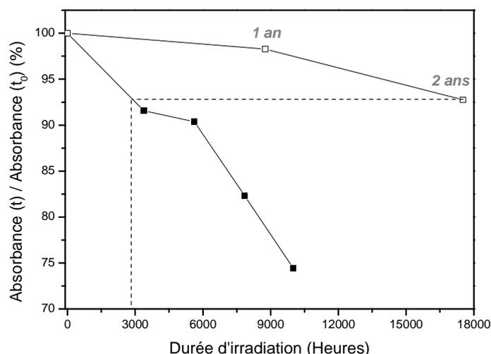
**Figure 71. Evolution de l'absorbance P3HT à 520 nm en absence d'oxygène**
