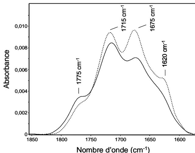
**Figure 40. Comparaison des spectres IR dans le domaine des carbonyles après photo- et thermo-oxydation, pour une même perte d'absorbance à 520 nm (~ 50%)**
