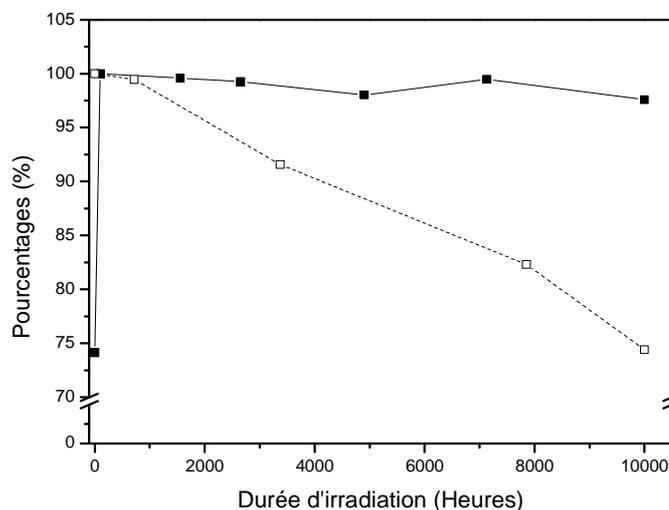
**Figure 80. Influence du PC<sub>60</sub>BM sur la vitesse de dégradation du P3HT au cours de la photolyse.**
