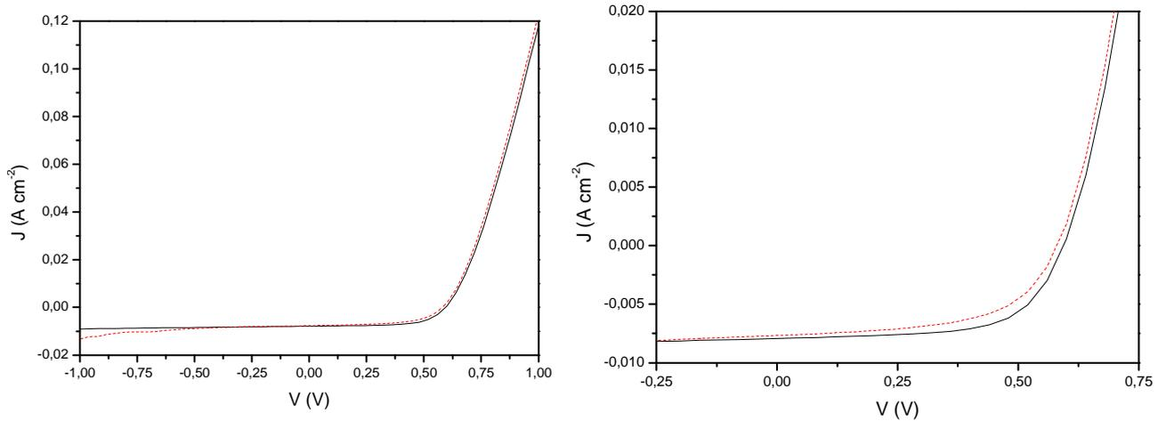
**Figure 117. Caractéristiques courant – tension sous éclaircissement d’une cellule après mise en tube (—) et d’une cellule vieillie 1000 heures sous vide en enceinte SEPAP 12-24 à T = 60°C (- - -)**
