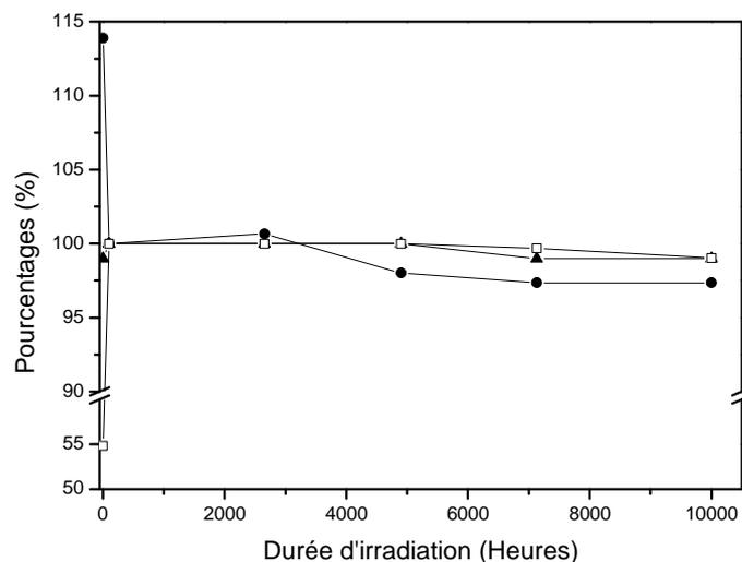
Figure 79. Cinétiques de photolyse du mélange P3HT / PC<sub>60</sub>BM à  $\lambda > 295$  nm et T = 60°C
