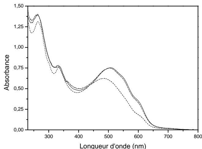
**Figure 75. Evolution du spectre d'absorption UV-visible du mélange P3HT / PC<sub>60</sub>BM au cours de la photolyse à  $\lambda > 295$  nm et T = 60°C (- - -) 0 h ; (-) 100 h ; (- • -) 10000 h**
