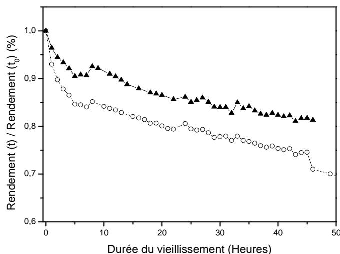
**Figure 106. Influence de la température de recuit du PEDOT:PSS sur l'évolution du rendement de photoconversion au cours du vieillissement des cellules sous irradiation continue (AM 1.5G) en boîte à gants à T = 35°C (○) recuit à T = 140°C ; (▲) recuit à T = 180°C**
