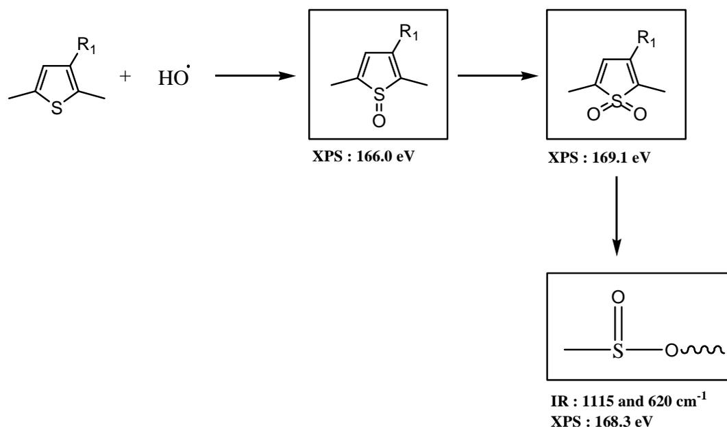
**Figure 62. Mécanisme d'oxydation photochimique et thermique du cycle thiophénique du P3HT**
