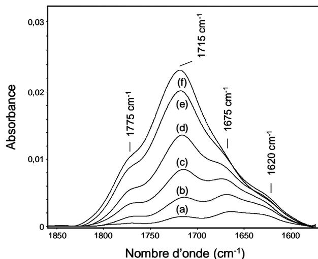
**Figure 34. Evolution du spectre IR du P3HT au cours de la photo-oxydation dans la zone des dérivés carbonylés. Soustraction entre le spectre de l'échantillon irradié et le spectre initial**
