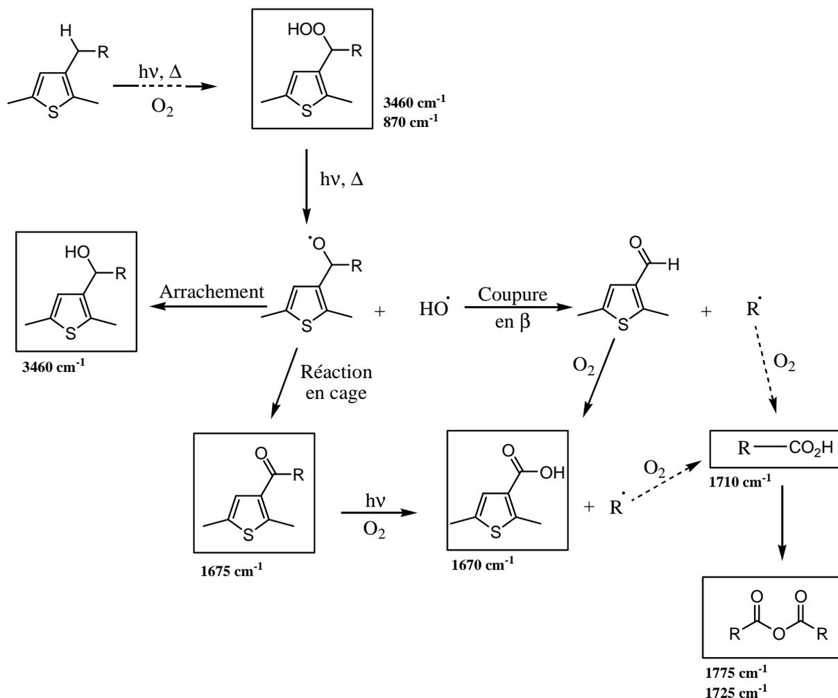
Figure 61. Mécanisme d'oxydation photochimique et thermique de la chaîne hexyle du P3HT
