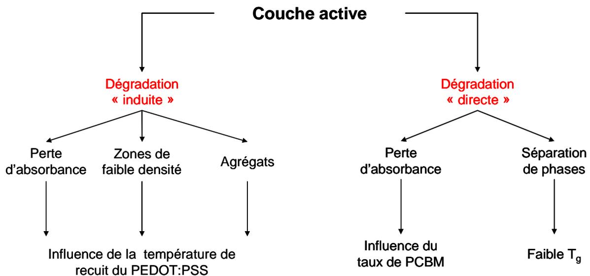
**Figure 110. Schéma de la dégradation photochimique en absence d'oxygène du mélange P3HT / PC<sub>60</sub>BM déposé sur Verre / ITO / PEDOT:PSS**
