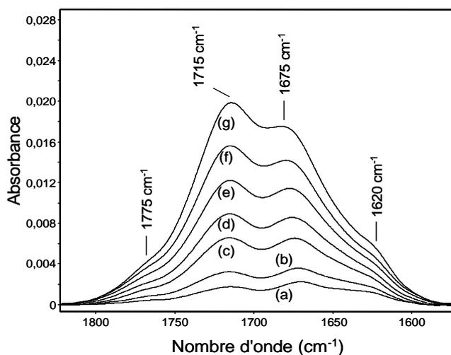
**Figure 41. Evolution du spectre IR du P3HT au cours de la thermo-oxydation à T = 60°C dans la zone des dérivés carbonylés. Soustraction entre le spectre de l'échantillon irradié et le spectre initial**
