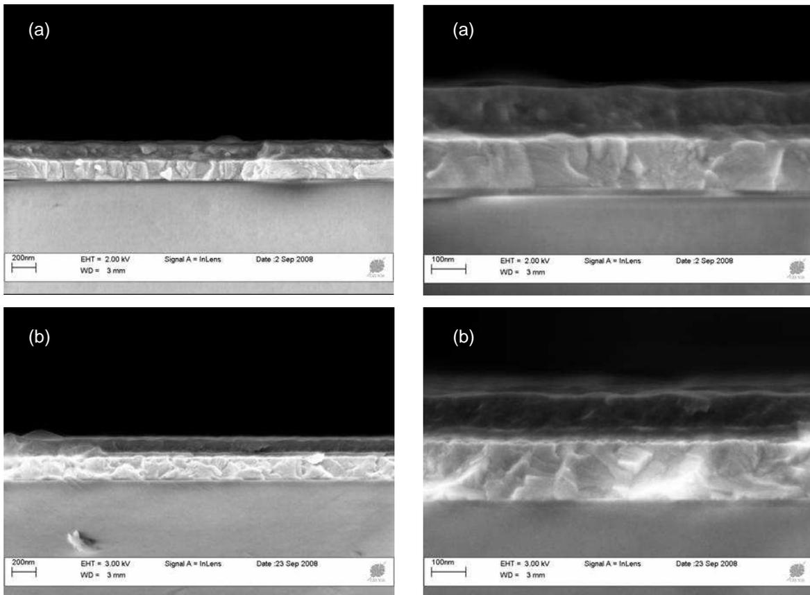
**Figure 91. Clichés MEB de la tranche d'un échantillon après (a) 1000 h et (b) 3000 h de photolyse**
