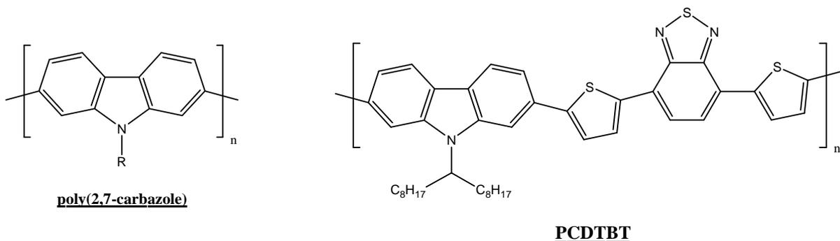
Figure 120. Structure chimique du poly(2,7-carbazole) et du PCDTBT
