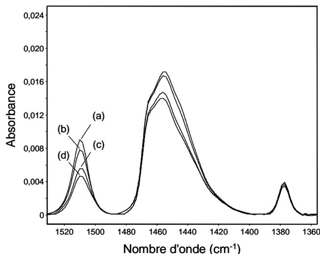
Figure 65. Evolution du spectre IR du P3HT au cours de la photolyse dans la zone  $1530 - 1360 \text{ cm}^{-1}$  (a) 0 h ; (b) 3375 h ; (c) 7850 h ; (d) 10000 h
