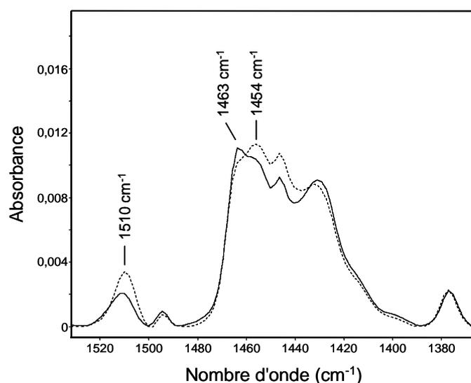
Figure 78. Evolutions du spectre IR du mélange P3HT / PC<sub>60</sub>BM au cours des premières heures de la photolyse dans la zone de vibration caractéristique des cycles thiophéniques (—) 0 h ; (---) 100 h
