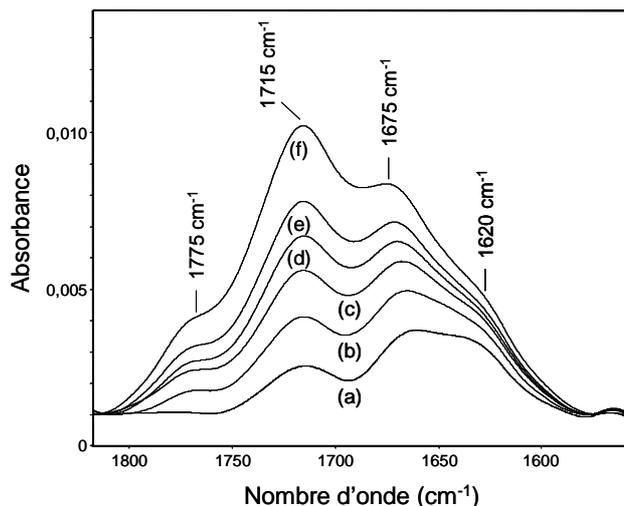
**Figure 49. Evolution du spectre IR du P3HT au cours de la photo-oxydation à  $\lambda > 400$  nm dans la zone des carbonyles. Soustraction entre le spectre de l'échantillon irradié et le spectre initial (a) 30 h ; (b) 50 h ; (c) 60 h ; (d) 70 h ; (e) 80 h ; (f) 100 h**
