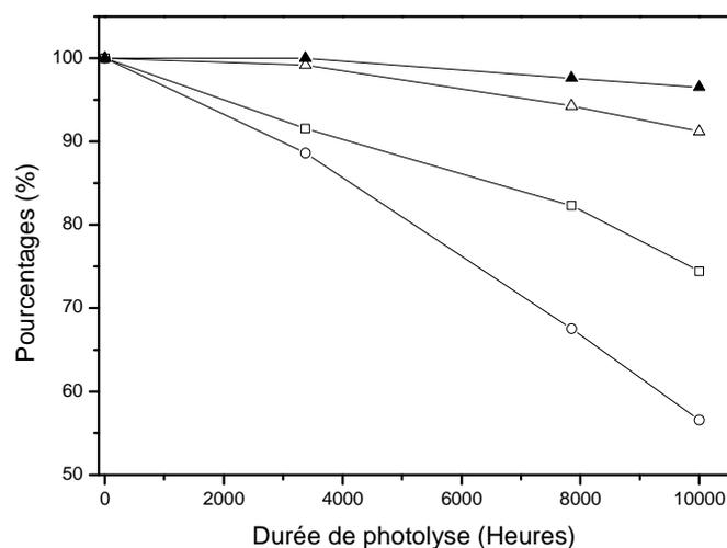
Figure 67. Cinétiques de photolyse du P3HT à  $\lambda > 295$  nm et  $T = 60^\circ\text{C}$
