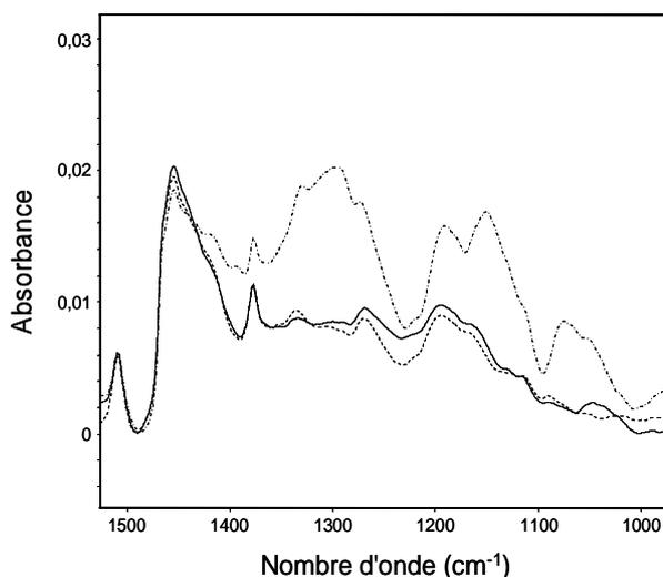
**Figure 43.** Comparaison des spectres IR dans le domaine de « l’empreinte digitale » après photo- et thermo-oxydation, pour une même perte d’absorbance à 520 nm (~ 50%)
