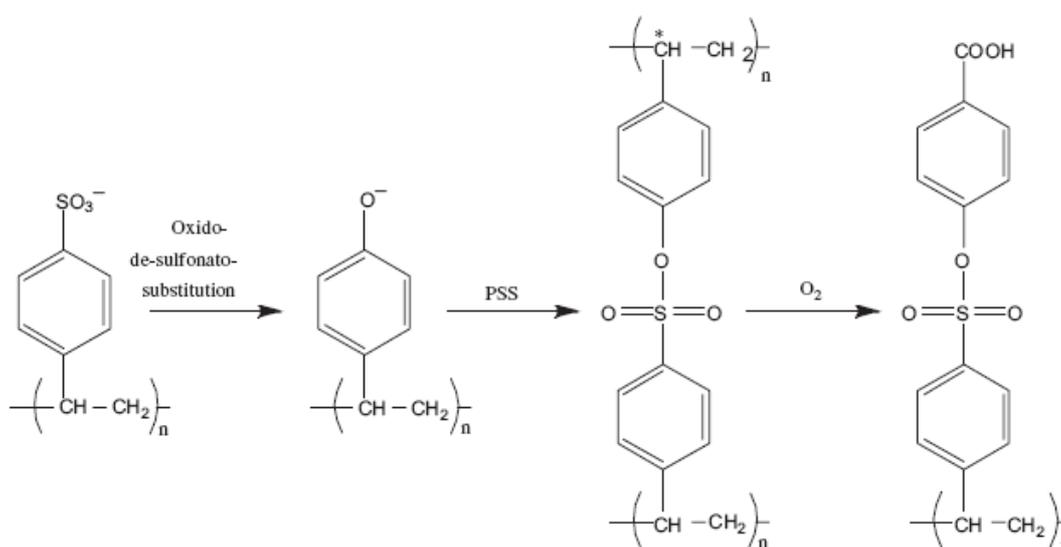
**Figure 10. Mécanisme de photo-dégradation en présence d'oxygène de la partie polystyrène sulfonate du PEDOT:PSS <sup>[84]</sup>**
