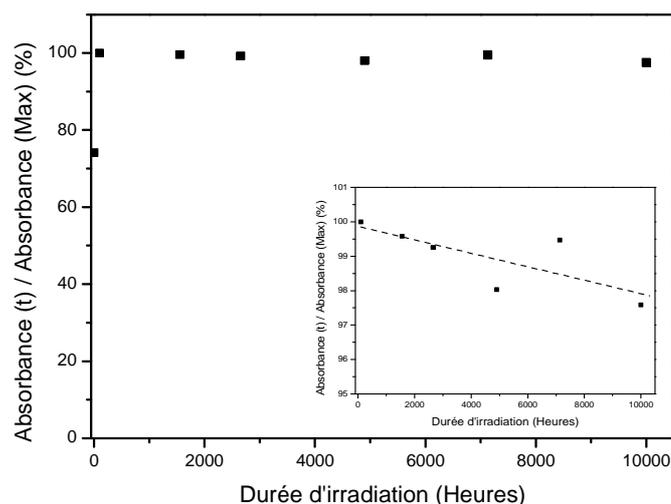
**Figure 76. Evolution de l'absorbance du mélange P3HT / PC<sub>60</sub>BM à 520 nm au cours de la photolyse à  $\lambda > 295$  nm et T = 60°C (Insert : zoom)**
