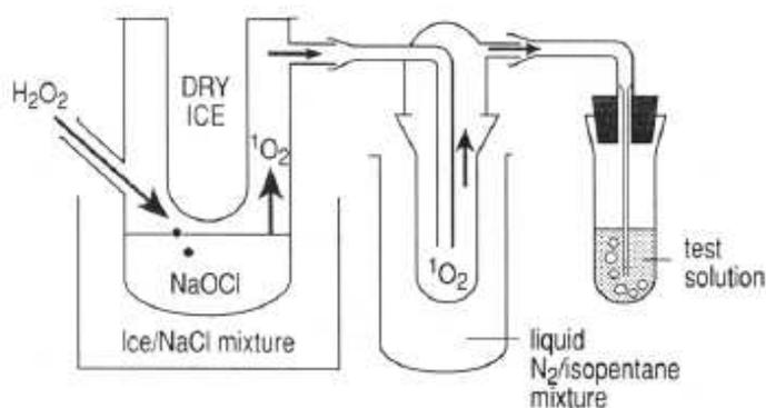
Figure 59. Schéma du montage expérimental utilisé par *Holdcroft et al.* pour étudier la réactivité de l'oxygène singulet vis-à-vis du P3HT <sup>[120]</sup>
