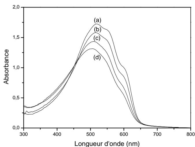
**Figure 63. Evolution du spectre d'absorption UV-visible du P3HT au cours de la photolyse à  $\lambda > 295$  nm et  $T = 60^\circ\text{C}$  (a) 0 h ; (b) 3375 h ; (c) 7850 h ; (d) 10000 h**
