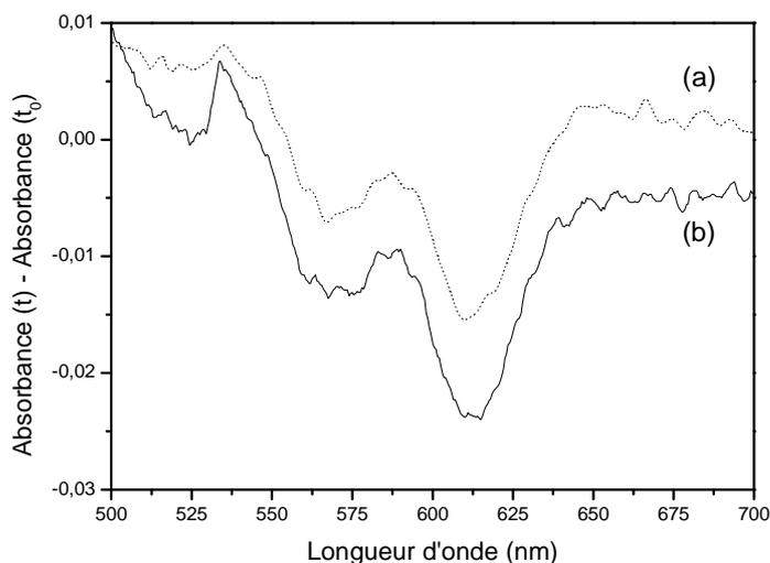
**Figure 85. Evolution de l'absorption UV-visible du P3HT au cours de la photolyse dans la zone  $500 < \lambda < 700 \text{ nm}$ . Soustraction entre le spectre de l'échantillon irradié et le spectre initial (a) 500 h ; (b) 1000 h**
