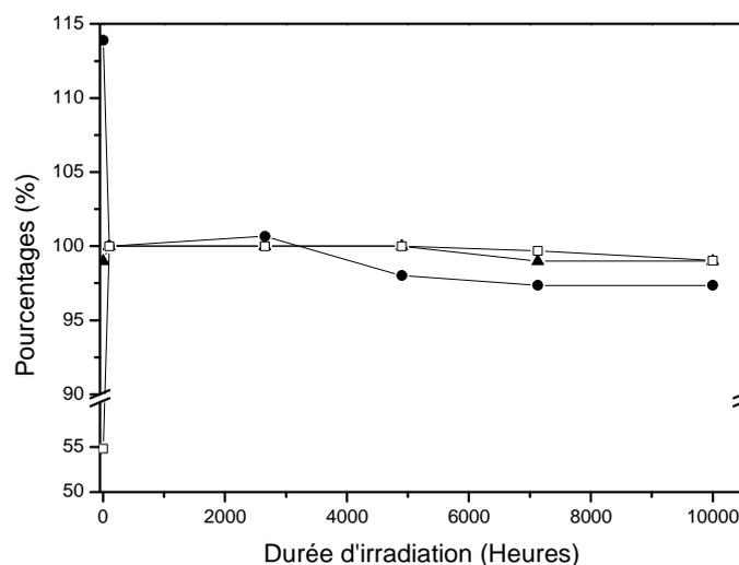
**Figure 79. Cinétiques de photolyse du mélange P3HT / PC<sub>60</sub>BM à  $\lambda > 295$  nm et T = 60°C**
