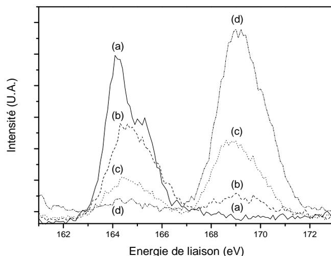
**Figure 52. Evolution du spectre du niveau S<sub>2p</sub> au cours de la photo-oxydation du P3HT**
