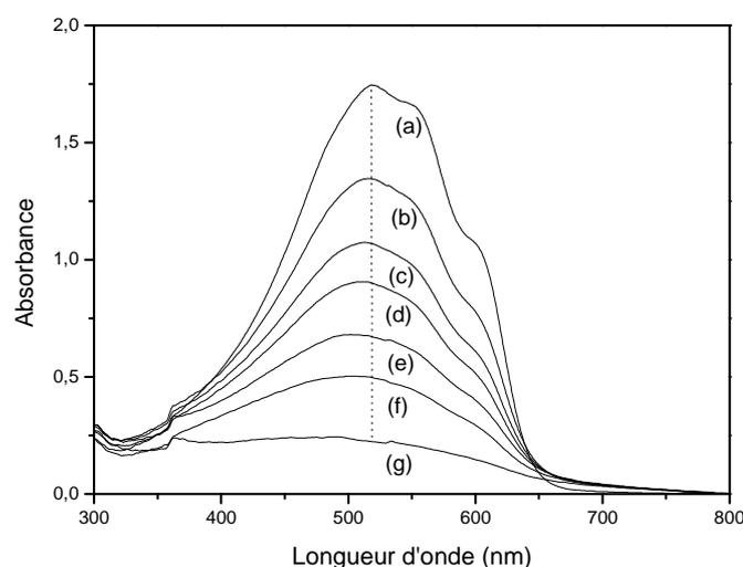
**Figure 31. Evolution du spectre d'absorption UV-visible du P3HT au cours de la photo-oxydation à  $\lambda > 295$  nm et  $T = 60^\circ\text{C}$  (a) 0 h ; (b) 15 h ; (c) 30 h ; (d) 40 h ; (e) 50 h ; (f) 60 h ; (g) 80 h**
