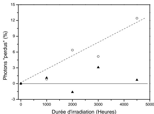
**Figure 103. Influence de la température de recuit du PEDOT:PSS sur le pourcentage de photons « perdus » au cours de la photolyse**
