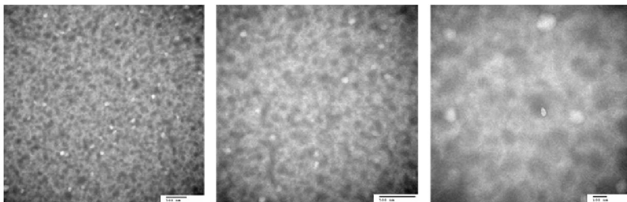
**Figure 99. Clichés MET de la couche active d'un échantillon après 3000 h de photolyse**
