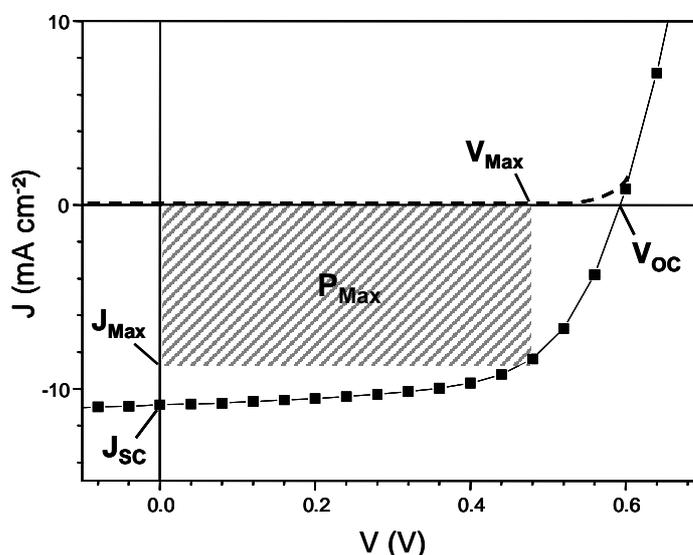
Figure 3. Caractéristiques courant – tension d'une cellule photovoltaïque
