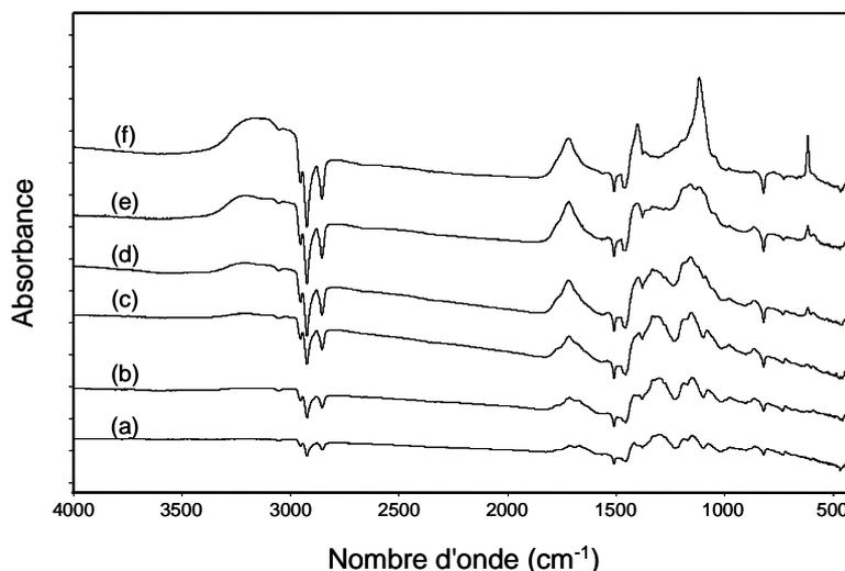
**Figure 33. Evolution du spectre IR du P3HT au cours de la photo-oxydation**
