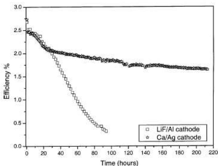
**Figure 13. Evolution du rendement de conversion d'une cellule sous irradiation continue (AM 1.5G, 1000 W m<sup>-2</sup>) en boîte à gants pour deux types de cathode <sup>[116]</sup>**
