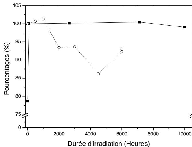
**Figure 87.** Evolution de l'absorbance du mélange P3HT / PC<sub>60</sub>BM entre 400 et 650 nm au cours de la photolyse (■) Dépôt sur substrat inerte (KBr) ; (○) Dépôt sur Verre / ITO / PEDOT:PSS
