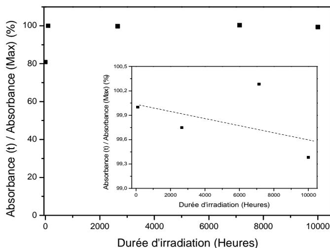
**Figure 77. Evolution de l'absorbance du mélange P3HT / PC<sub>60</sub>BM entre 350 et 800 nm au cours de la photolyse à  $\lambda > 295$  nm et  $T = 60^\circ\text{C}$  (Insert : zoom)**
