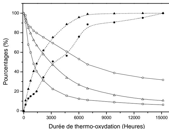
Figure 44. Cinétiques de thermo-oxydation du P3HT à 100°C
