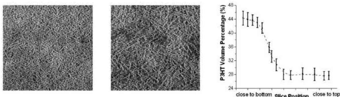
**Figure 8. Mise en évidence par tomographie électronique du gradient de composition vertical de la couche active P3HT / PC<sub>60</sub>BM d'une cellule après recuit thermique. Clichés MET (1,7 µm x 1,7 µm) d'une tranche située respectivement à proximité de l'anode (Gauche) ; à proximité de la cathode (Centre) ; évolution de la fraction volumique de P3HT en fonction de l'épaisseur (Droite) [73]**
