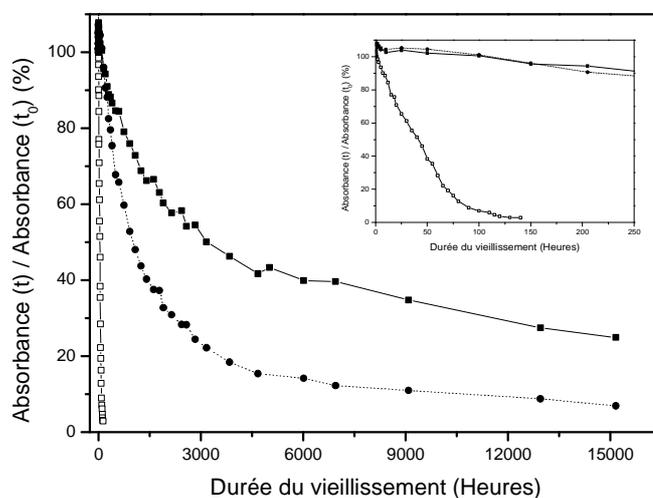
**Figure 39. Evolution de l'absorbance à 520 nm dans différentes conditions de vieillissement**
