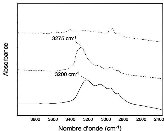
**Figure 56. Traitement SF<sub>4</sub> puis thermolyse d'un échantillon de P3HT photo-oxydé 90 h**
