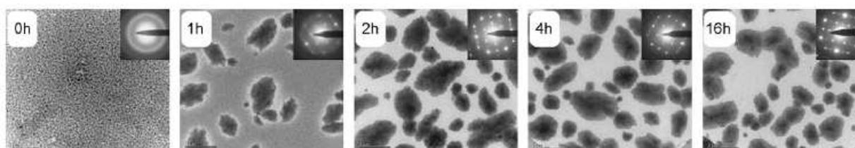
**Figure 11. Clichés de microscope optique (10 µm x 10 µm) d'une couche active MDMO-PPV / PC<sub>60</sub>BM (1 / 4 en masse) après différentes durées de recuit à 110°C [102]**
