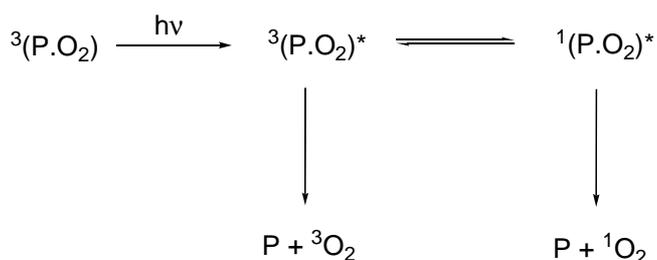
**Figure 15. Mécanisme de formation de l'oxygène singulet par dissociation d'un complexe à transfert de charge (CTC) à l'état excité**
