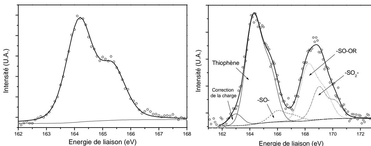
**Figure 53. Déconvolution du niveau de cœur  $S_{2p}$  du P3HT**
