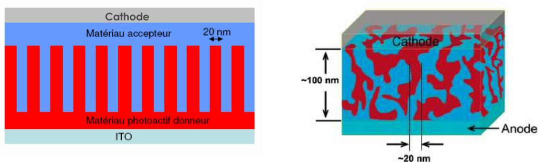
**Figure 6. Morphologie de la couche active d'une cellule à hétérojonction en volume**
