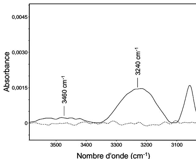
**Figure 54. Traitement SF<sub>4</sub> d'un échantillon de P3HT photo-oxydé 40 h**
