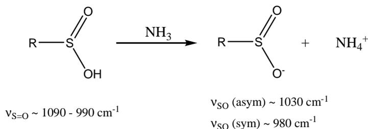
**Figure 27. Réaction de dérivation des acides sulfiniques en ions sulfinate par l'ammoniac**
