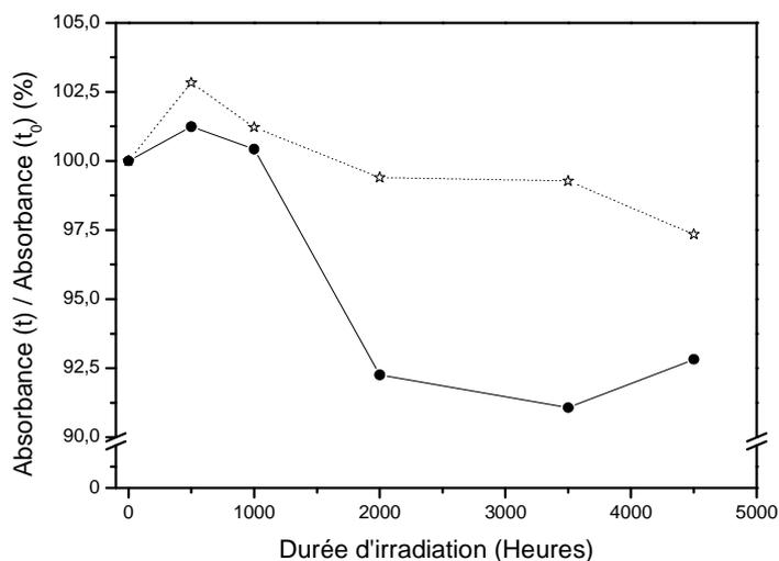
**Figure 108.** Evolution de l'absorbance entre 400 et 650 nm au cours du vieillissement photochimique pour différents ratios massiques P3HT / PC<sub>60</sub>BM (★) 1:1 ; (●) 1:0,6
