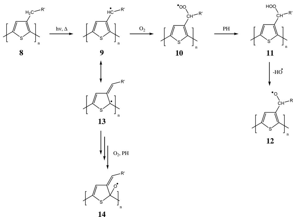
Figure 17. Mécanisme réactionnel de formation des macro-radicaux alcoyles lors de la photo- ou de la thermo-oxydation du P3HT <sup>[121]</sup>
