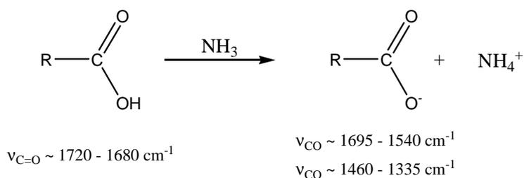
**Figure 25. Réaction de dérivation des acides carboxyliques en ions carboxylates par l'ammoniac**
