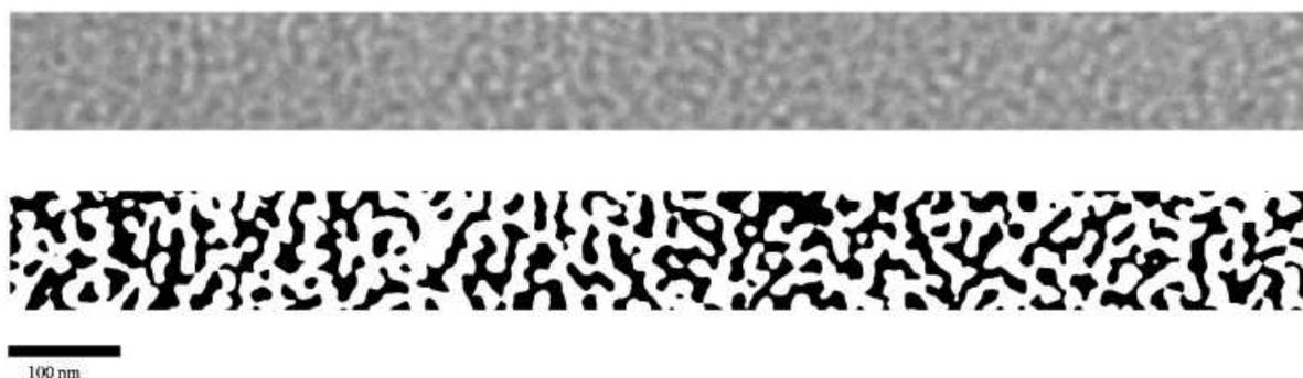
**Figure 7. Morphologie d'une section de la couche active P3HT / PC<sub>60</sub>BM d'une cellule à hétérojonction volumique : (Haut) cliché MET ; (Bas) image binaire de ce cliché [70]**
