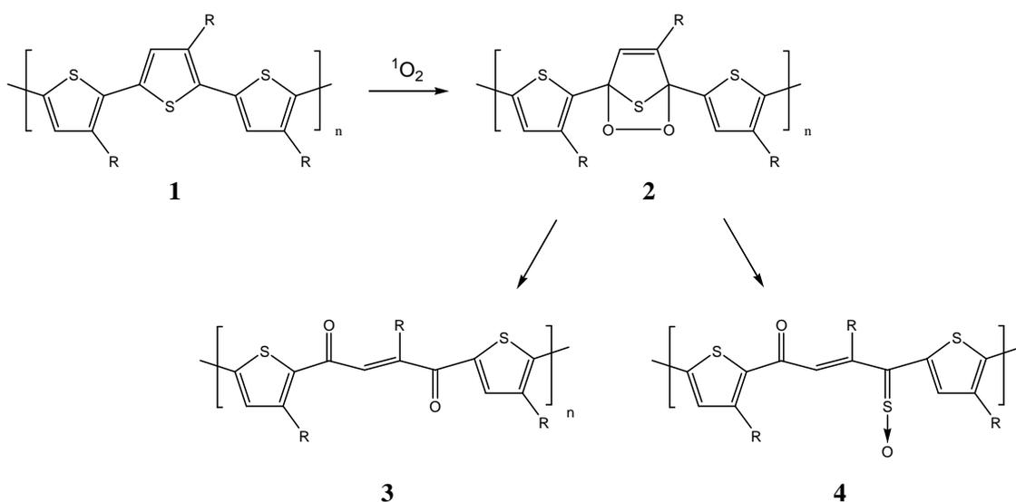
**Figure 14. Mécanisme réactionnel de déconjugaison du P3HT faisant intervenir l'oxygène singulet <sup>[121]</sup>**
