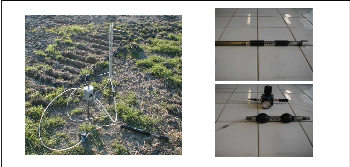
Figure 42 : Photos du perméamètre in situ
