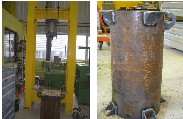
Figure 52: Dispositif de préparation des essais et des moules
