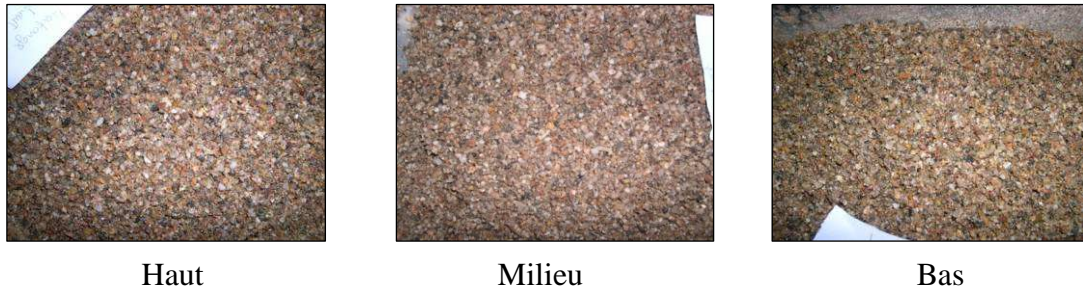
Figure 85 : Colonne colmatée (R-Lafarge) : images prises en haut au milieu et en bas de la colonne
