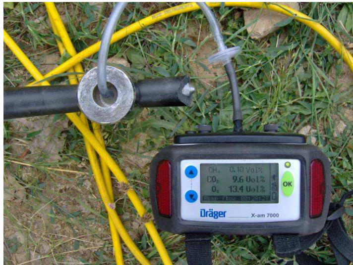
Figure 45 : Analyseur de gaz DrägerSensor XS relié à une sonde fixe lors d'une mesure sur filtres
