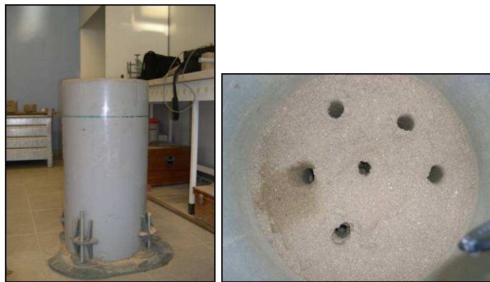
Figure 58 : Moule et configuration utilisée pour les mesures de résistivité électrique
