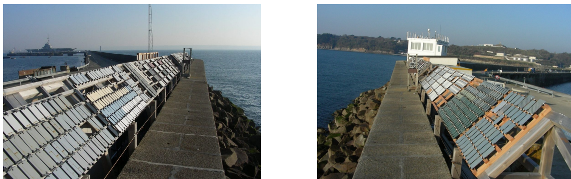
FIGURE 2.6 – Site d'exposition en atmosphère marine de l'Institut de la Corrosion, base navale, Brest
