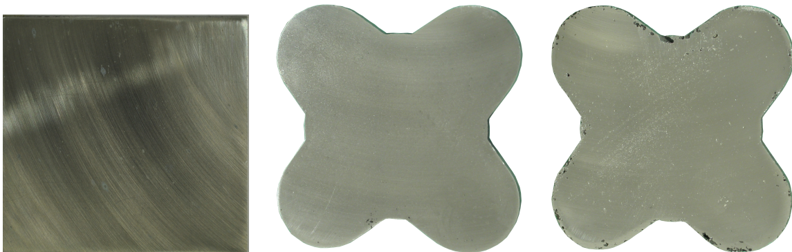
FIGURE 4.9 – Aspect visuel, de gauche à droite, des échantillons de Zn , Mg_2Zn_{11} et MgZn_2 - exposés à 80% HR 35^\circ \text{C} pendant 4 jours
