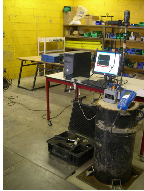
Figure 3-24 : exemple d'essais de chargement dynamique sur chambre d'étalonnage.
