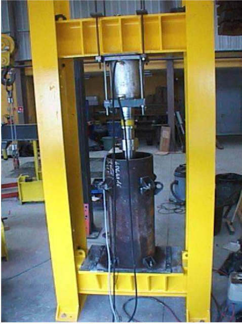
Figure 3-23 : confection d'éprouvette sous compactage quasi statique (cf. Chaigneau, 2001).
