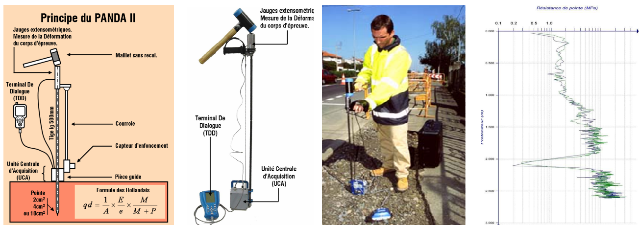
Figure 2-1 (a) Principe du pénétromètre dynamique Panda 2, (b) Ensemble Panda 2, (c) Contrôle de compactage à l'aide du Panda 2, et (d) Pénétrogrammes obtenus et visualisables sur le TDD.
