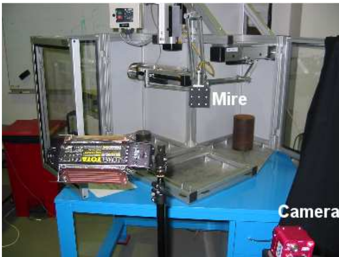
FIG. 3.26 – Montage utilisé pour la commande extéroceptive de l'Orthoglide
