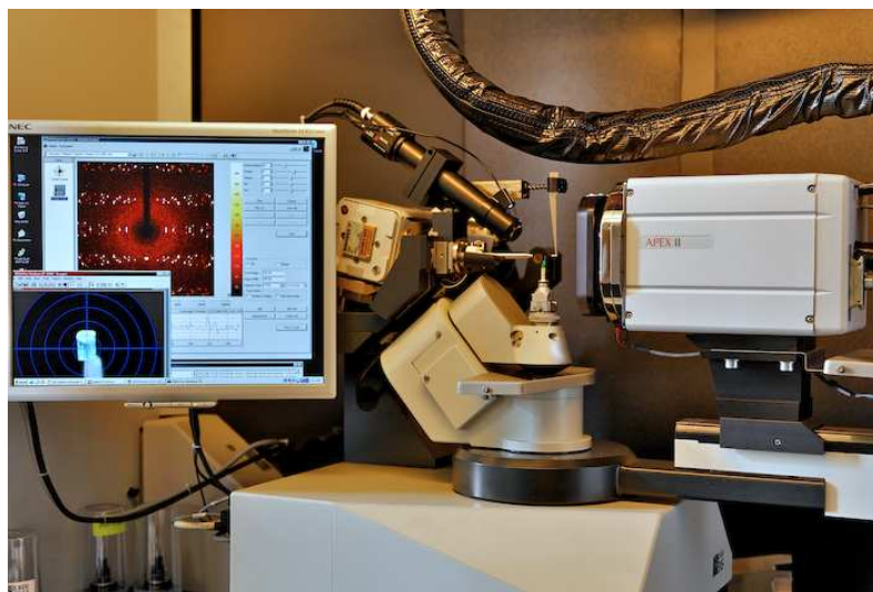
Figure I-2: Diffractomètre automatique Bruker Apex II.
