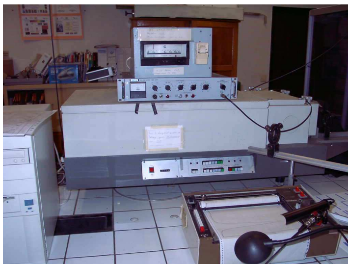
Figure II-2: Système d'échantillonnage du signal (BOXCAR PAR 162/164).
