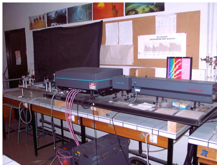
Figure II-1: Laser à colorant pompé par un laser YAG : \text{Nd}^{3+} à impulsions.
