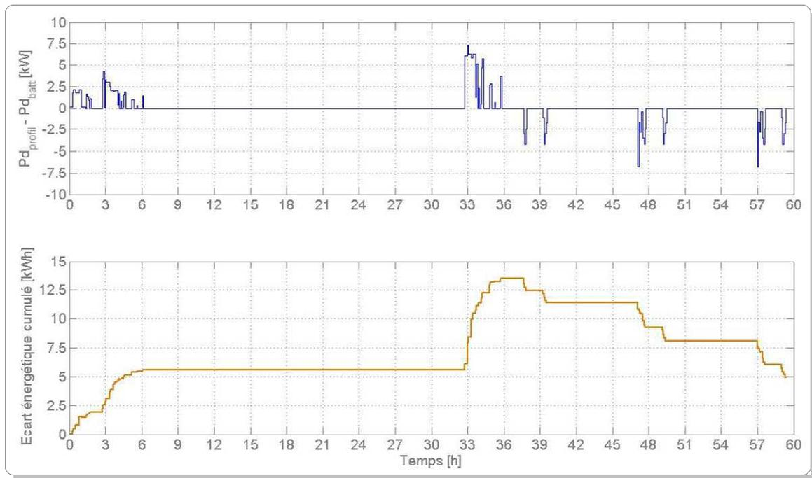
Figure 82. Écarts entre le profil demandé et la réponse de la batterie en fonction du temps en puissance (haut) et en énergie cumulée (bas).
